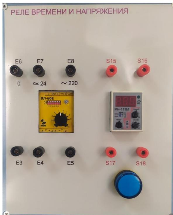
Рис. П1.5. Монтажный блок «реле времени и напряжения»
