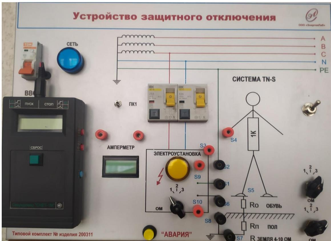
Рис. П2.1. Лабораторный стенд «Устройство защитного отключения»
