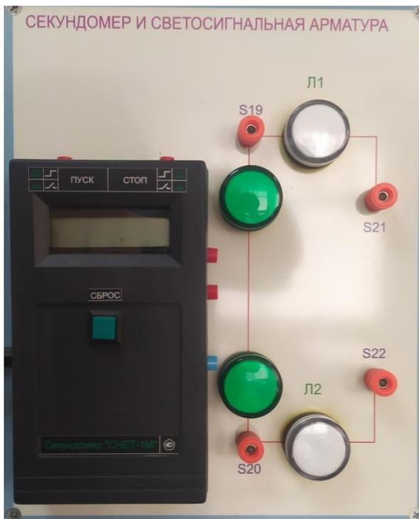
Рис. П1.3. Монтажный блок «Секундомер и светосигнальная арматура»
