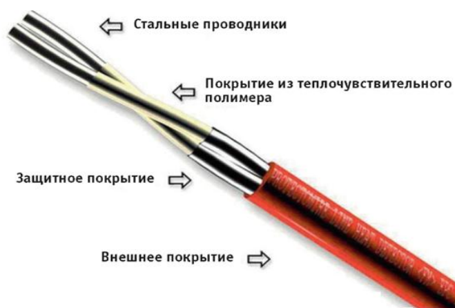
Рис.2.5. Линейный тепловой пожарный извещатель
