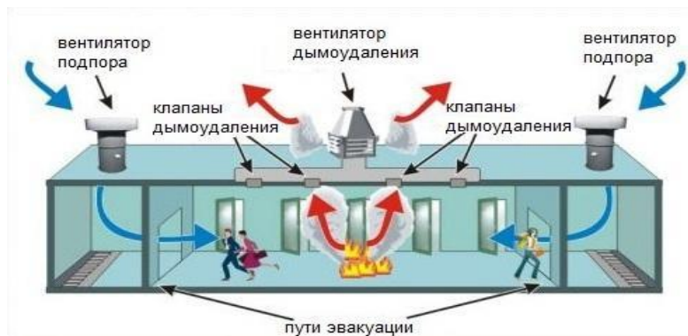
Рис. 20. Противоподымная защита помещений (способы защиты) ( https://slide-share.ru/protivodimnaya-zashchita-zdanij-194425 )
