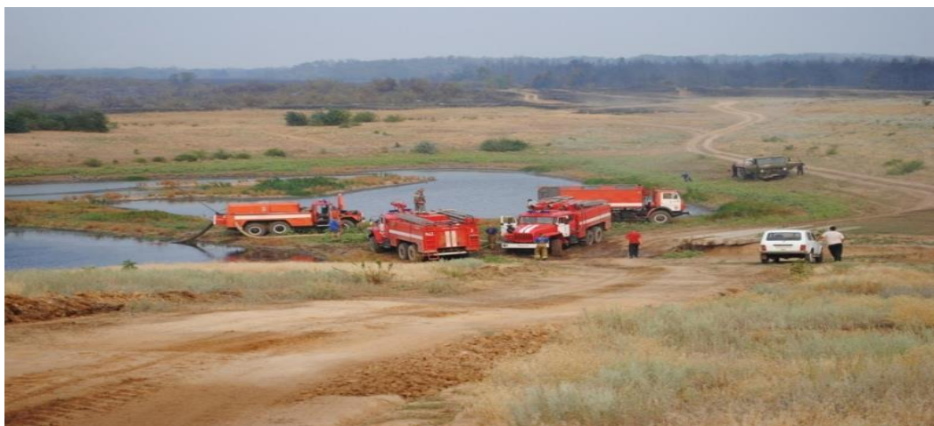
Рис. 27. Источники наружного противопожарного водоснабжения
