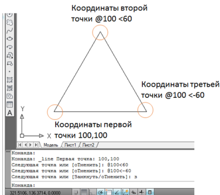
Рис. 1.21. Построение треугольника с помощью команды «Отрезок» в относительных полярных координатах
