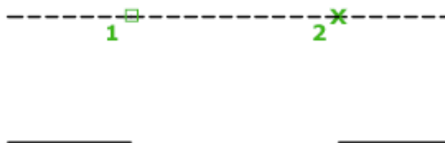
Рис. 3.5. Принцип работы команды «Разорвать»
