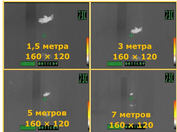
**ВАЖНО!** Тепловизор с разрешением 160 × 120 позволит обнаружить руку взрослого человека примерно с 2,5 метров (смотри рисунок). Тепловизор с разрешением 320 × 240 уже с 5 метров, 384 × 288 – с 7 метров.
