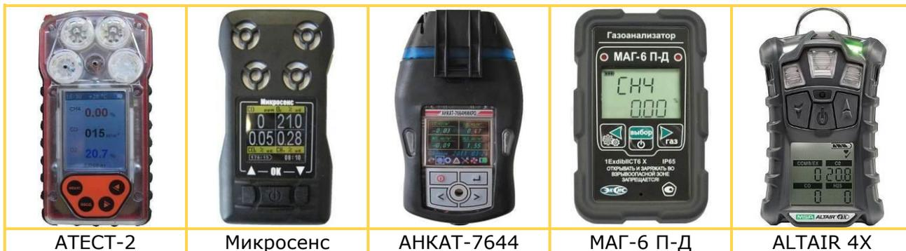
Газоанализаторы в зависимости от числа сенсоров в приборе могут быть одно-, двух- или многокомпонентными. И в зависимости от требований могут измерять концентрации метана (CH<sub>4</sub>), кислорода (O<sub>2</sub>) и оксидов углерода (CO и CO<sub>2</sub>), сероводорода (H<sub>2</sub>S), цианистого водорода (HCN), оксидов азота (NO и NO<sub>2</sub>) и др.
