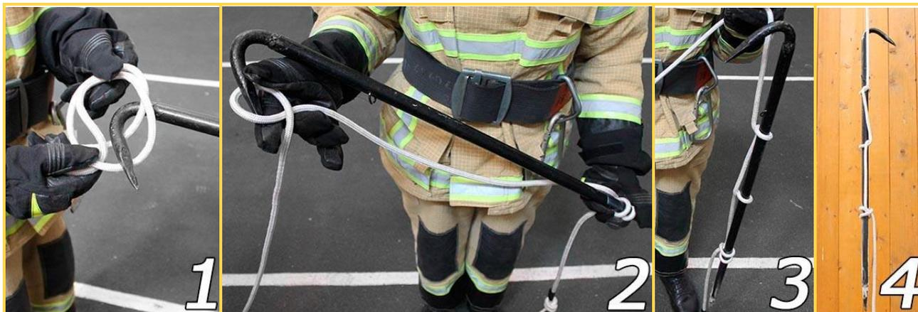
Связать узел «стремя» и надеть его на лом через крюк (1). Сделать два полуштыка через крюк лома (2, 3). Поднять лом (4)
