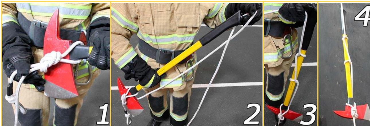
Петлю, полученную с помощью узла проводника «восьмерка», надеть на топорнице (1). Обнести веревку вокруг топора (2) и сделать два полуштыка на топорнице (3). Поднять топор (4)
