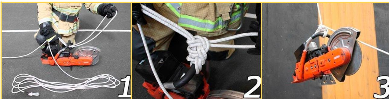
Создать необходимый запас веревки, сформировав открытую петлю (1). Закрепить ее на рукоятке бензопилы простыми полуштыками (2). Поднять бензопилу, отводя от здания (3)
