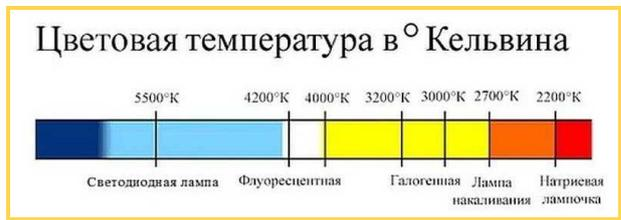
Свет, проходя через дым, отражается от его частиц. Его проникающая способность тем больше, чем ниже цветовая температура, поэтому фонари с теплым светом лучше «пробивают» дым. Однако в условиях слабого
