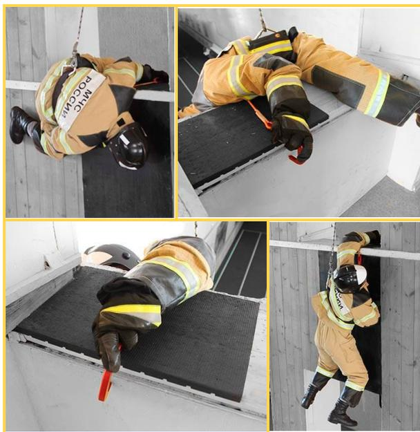
Спуск производится нажимом на рычаг тормозного устройства и отведением ходового конца веревки выходящий из сумки.
