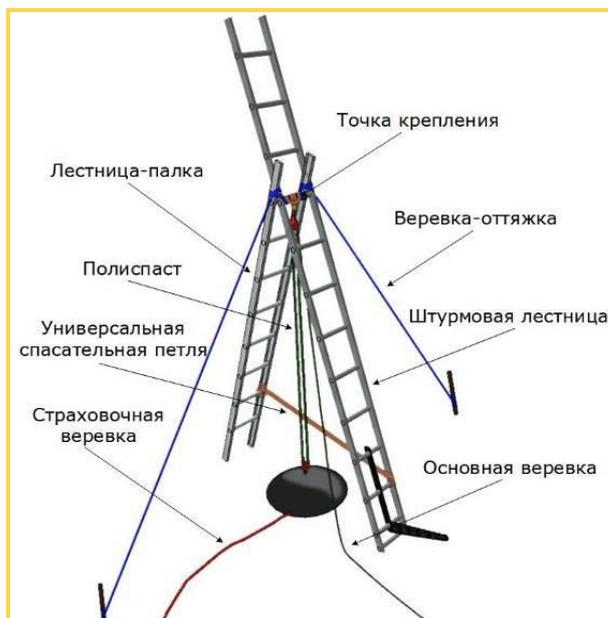
Соединение лестниц производится спасательной веревкой. Для этого веревку делят пополам и каждым концом веревки с помощью узла «стремя» связываются тетивы двух лестниц между собой с каждой стороны. Оставшийся запас веревки используется для создания оттяжек.
