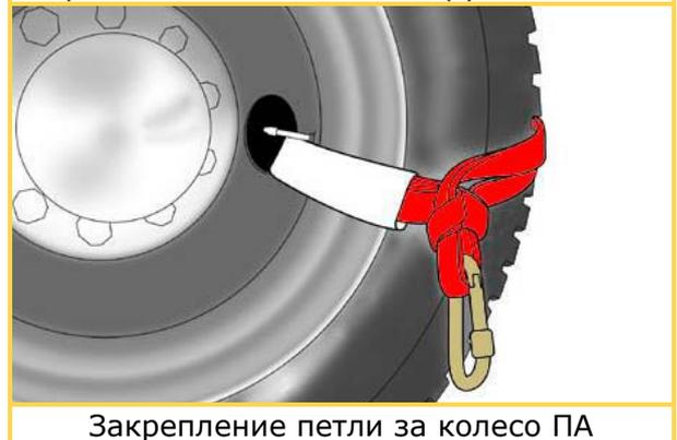
Закрепление петли за колесо ПА
