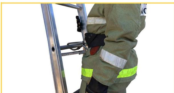
Самостраховка при работе на высоте для пожарных поясов типа Б проводится с помощью страховочного уса.
