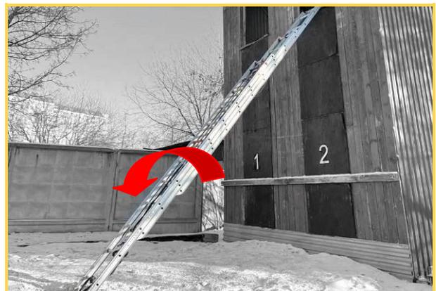
**ВАЖНО!** Установленная лестница должна быть перевернута, чтобы предотвратить зацепы щита при его подъеме на переходах с одного колена на другое. Чтобы компенсировать нагрузки на лестницу, одному пожарному рекомендуется держать лестницу снизу.
