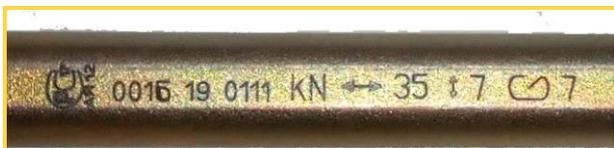
Параметры разрывной нагрузки карабина
