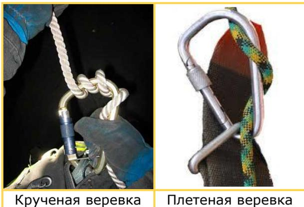
Наибольшее распространение в пожарной охране получили плетеные веревки, которые имеют кабельную конструкцию. Они состоят из двух частей: плетеная оболочка, которая защищает сердцевину.
