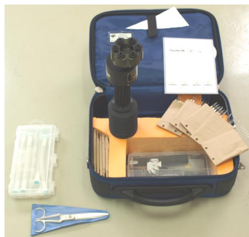
Рис. 1.5. Газоанализатор химический многоканальный для экспертизы пожаров
