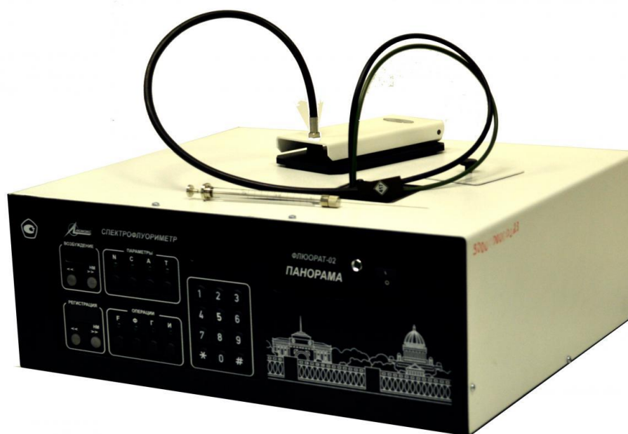
Рис. 2.1. Внешний вид спектрофлуориметра «Флюорат-02 Панорама»
