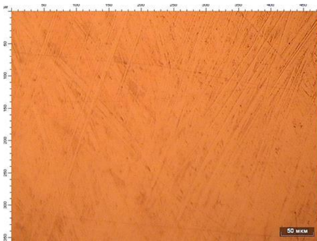
в) после финальной полировки суспензией 0,05 мкм
