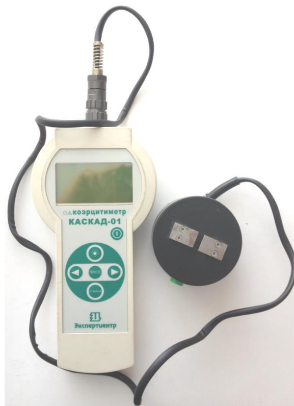
Рис. 6.2. Коэрцитиметр импульсный микропроцессорный «Каскад»
