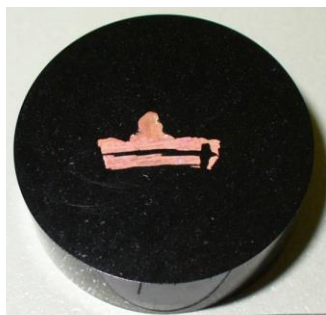
б) микрошлиф (запрессовка при помощи автоматического прессы)
