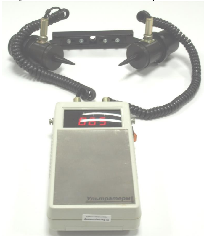
Рис. 7.1. Ультразвуковой приборный комплекс «Ультратерм»
