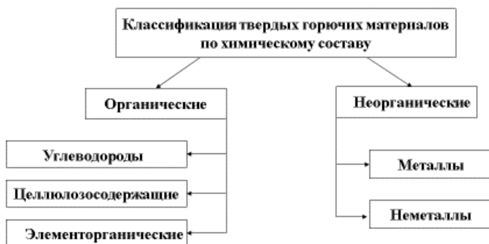
Рис. 2.12. Классификация ТГМ по химическому составу
