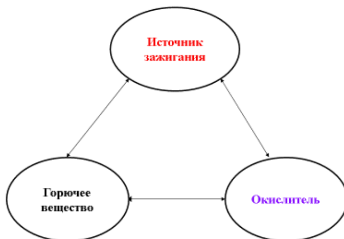
Рис. 4.1. Схема «треугольника горения»
