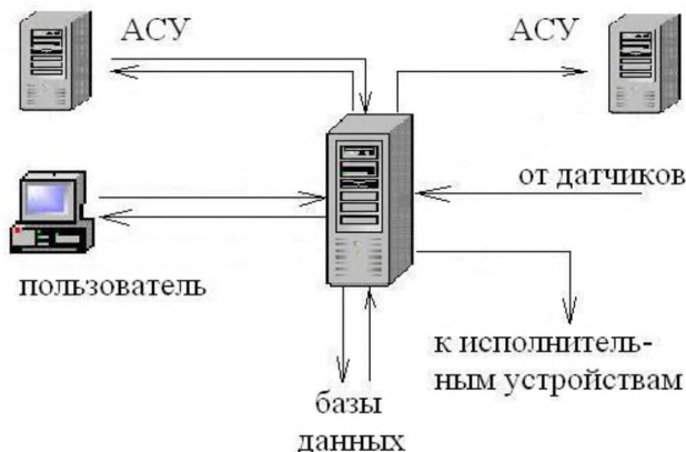
Рис. 5.1. Функциональная схема АСУ
