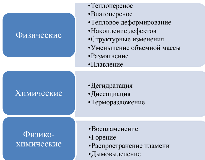
Рис. 2. Процессы, происходящие в материалах под воздействием факторов пожара
