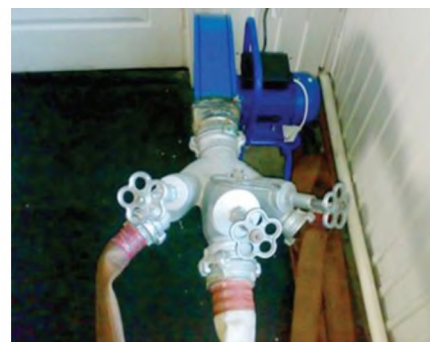
Рис. 2. Возможность присоединения двух-трех пожарных рукавов
