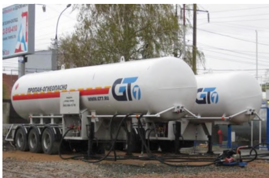
Рис. 1. АГЗС - несоблюдение противопожарных расстояний, г. Екатеринбург
