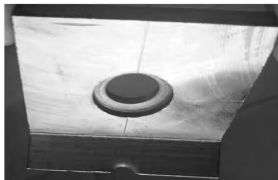
Рис. 6. Смятие режущей кромки сменного лезвия
