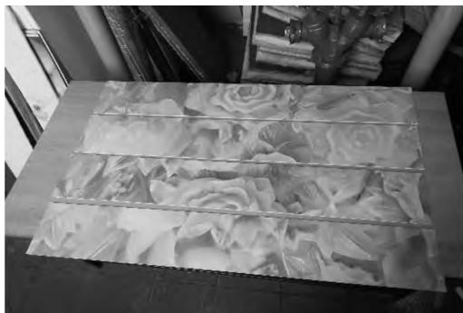
Рис. 1. Фото образца для испытания на горючесть
