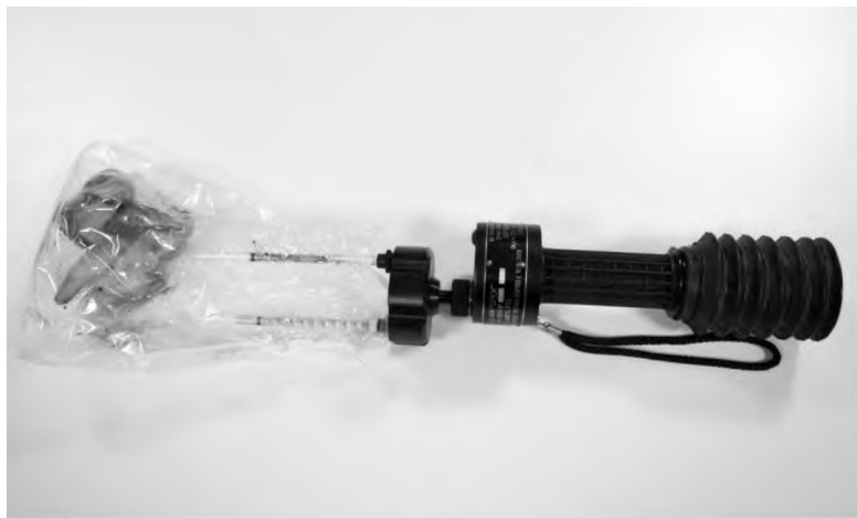
Рис. 1. Проведение измерения представленного на исследование объекта газоанализатором сильфонного типа АМ – 0059
