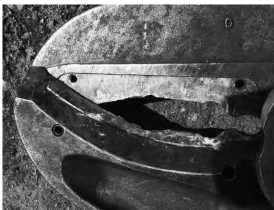
Рис. 1. Износ режущей кромки гидравлических кусачек (Вид дефекта: скол режущей части)
