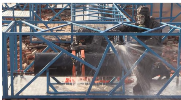
Рис. 6. Модуль разгерметизации емкости под избыточным давлением
