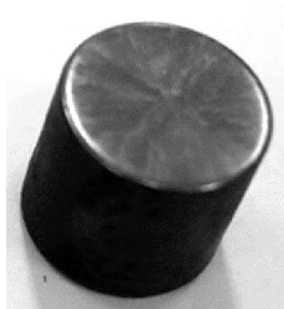
Рис. 1. Микрошлиф (протравленный) белый доэвтектический чугуна
