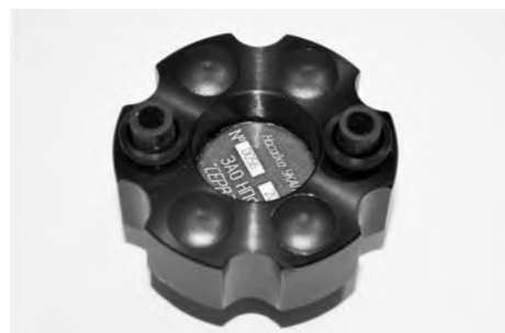
Рис. 3. Двухканальная насадка под установку трубок «аммиак» и «сероводород» для газоанализатора сильфонного типа АМ – 0059
