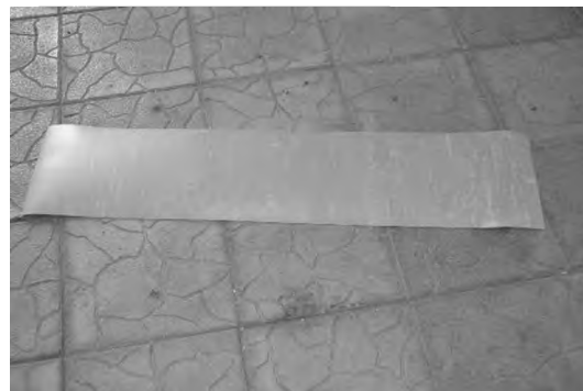
Рис. 5. Фото образца для испытания на распространение пламени
