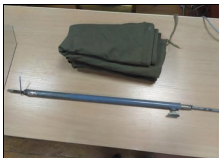
Рис. 1. Отдельные элементы дымонепроницаемой мембраны в сложенном состоянии
