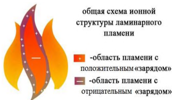
Рис. 1. Общая схема ионной структуры ламинарного пламени
