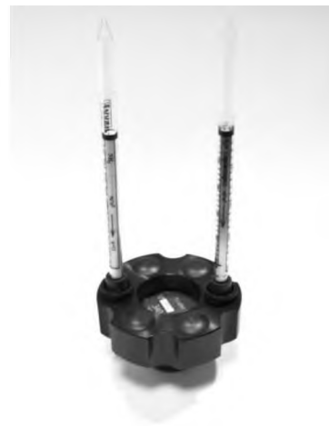
Рис. 2. Изменение окраски индикаторных трубок после исследования
