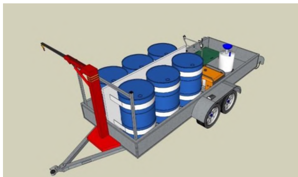
Рис. 2. Модель прицепного поста для замены технических жидкостей и смазок пожарных автомобилей
