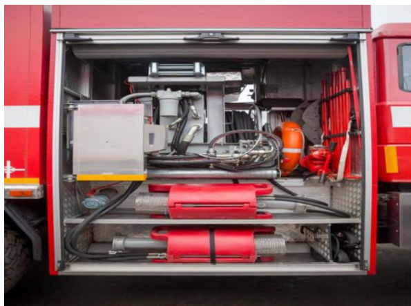
Рис. 3. Погружные насосы HFS-19 в отсеке ПАНРК
