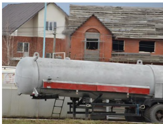
Рис. 4. АГЗС - несоблюдение противопожарных расстояний, г. Бердск
