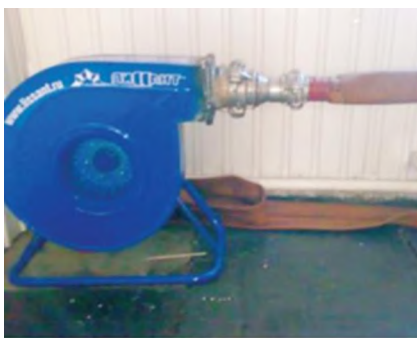
Рис. 1. Использование устройства для сушки одного пожарного рукава
