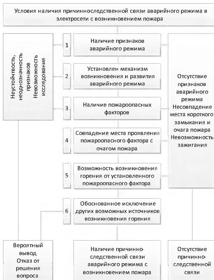
Рисунок. Критерии оценки причинно-следственной связи аварийного режима в электросети с возникновением пожара [3]
