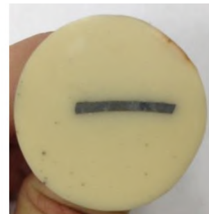
Рис. 2. Микрошлиф из чугуна, залитый в карбодент
