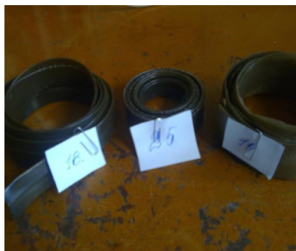
Рис. 2. Опытные образцы полимерной ленты с содержанием антипирена
