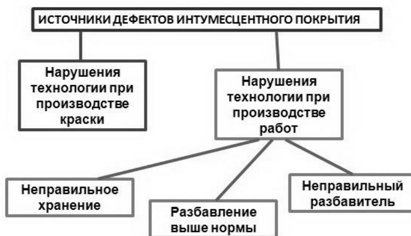
Рис. 1. Причины нарушения интумесцентной огнезащиты
