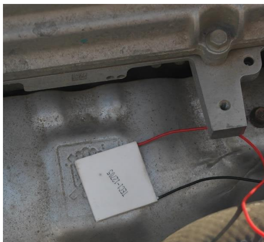
Рис. 1. Элемент Пельтье на крышке выпускного коллектора двигателя автомобиля
