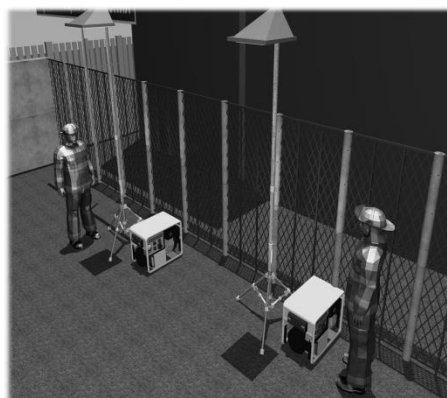
Рис. 5. Место установки оборудования для организации освещения участка проведения аварийно-спасательных работ
