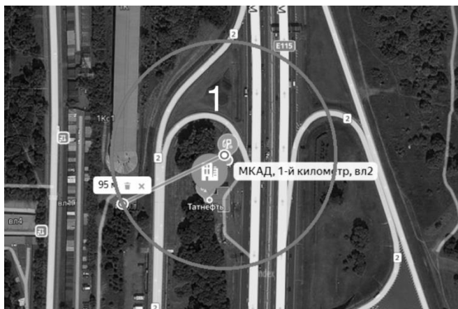
Рис. 1. Зона поражения людей высокотемпературными продуктами сгорания при пожаре-вспышке для проектной аварии (разрушение резервуара хранения СУГ объемом 10 \text{ м}^3 ) составит 95 м
