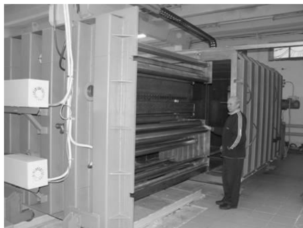
Рис. 2. Установка MM-180 для нанесения покрытий на ткани и полимерные пленочные материалы методом ионно-плазменного распыления
