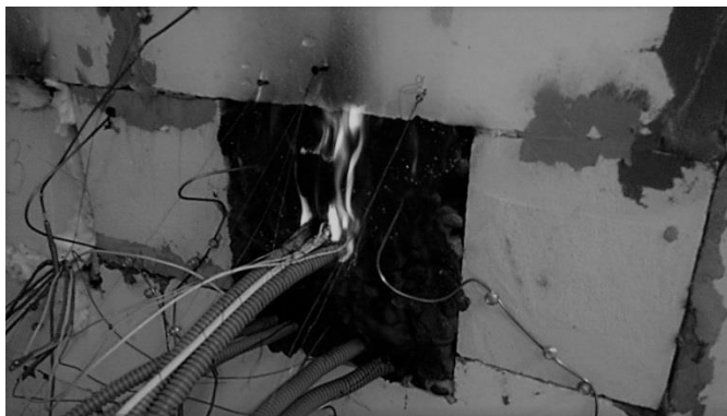
Рис. 4. Прорыв пламени на необогреваемой поверхности заделочного материала образца № 4
