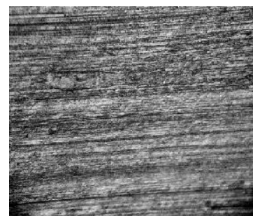
Рис. 8. Поверхность металлического вкладыша после трения в смазочной композиции содержащей 10 % наполнителя – искусственный серпентин, полученный по золь-гель технологии (увеличение x 500)
