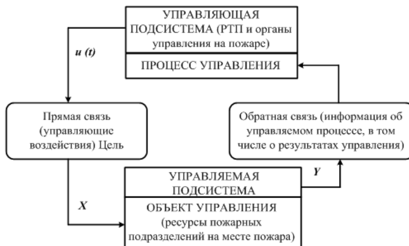
Рис. 1. Элементы единой системы управления [3]: u(t) – закон управления, X – управляющая команда (сигнал), Y – отчет о реализации управляющего сигнала
