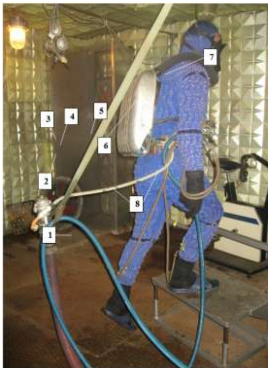
Рис. 2. Выполнение упражнения «степ-тест»: 1 – пожарный рукав; 2 – водоотборное устройство; 3 – рукавная заглушка; 4 – быстроразъемное соединение; 5 – шланг, подающий воду в комбинезон водяного охлаждения; 6 – входной коллектор; 7 – комбинезон водяного охлаждения; 8 – выпускные коллектора
