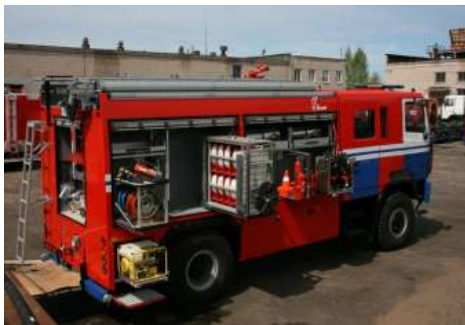
Рис. 6. Размещение оборудования с правой стороны ПАЦ
