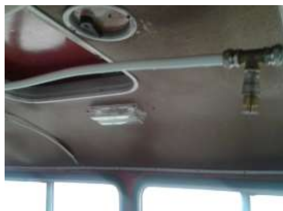
Рис. 2. Размещение оросителей в салоне транспортного средства (автобуса)
