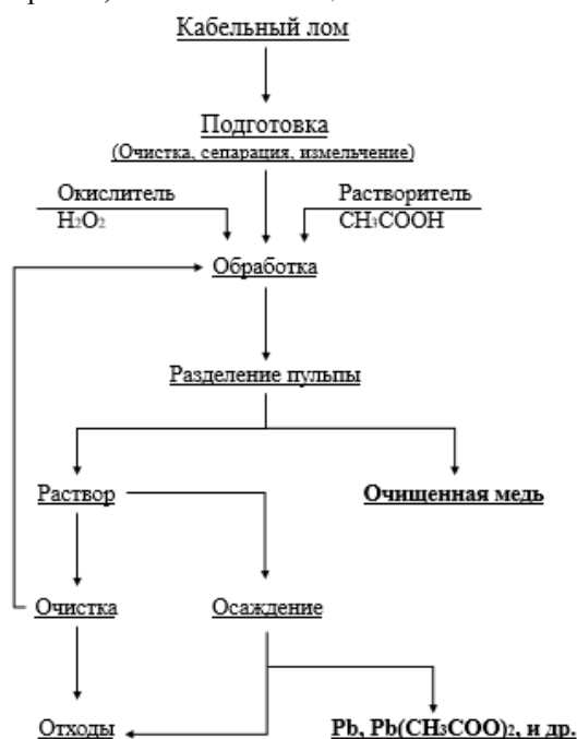
Рис. 2. Схема переработки кабельного лома с извлечением свинца по гидromеталлургической технологии
