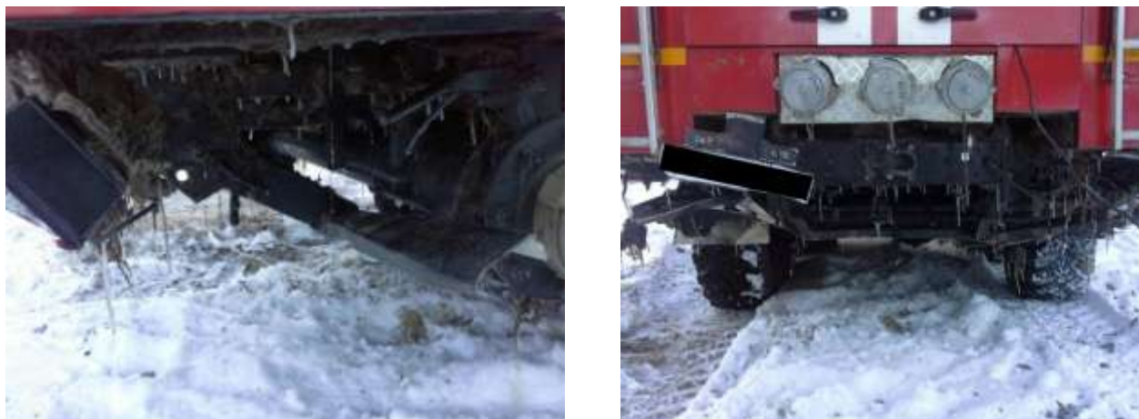
Рисунок. Повреждения пожарного автомобиля после вытаскивания из заболоченного участка дороги
