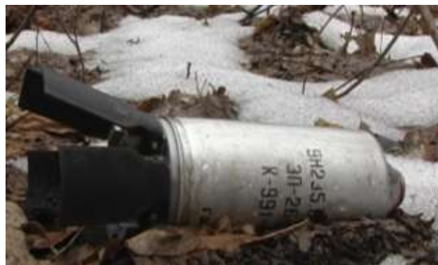
Рис. 4. Неразорвавшийся осколочный боевой элемент 9H235 «Попрыгунья» (96 осколков массой 4,5 г, 360 осколков массой 0,75 г), широко применяемый Вооруженными силами Украины в кассетных снарядах РСЗО «Смерч» и «Ураган» на Востоке Украины
