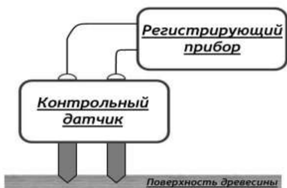
Рис. 2. Схема устройства для контроля наличия огнезащитных обработок на конструкциях из древесины
