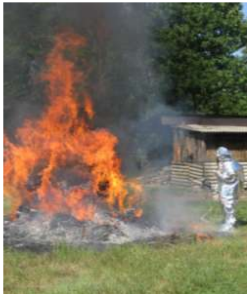
Рис. 5. Перемещение испытателя с пожарным стволом вдоль фронта очага пожара
