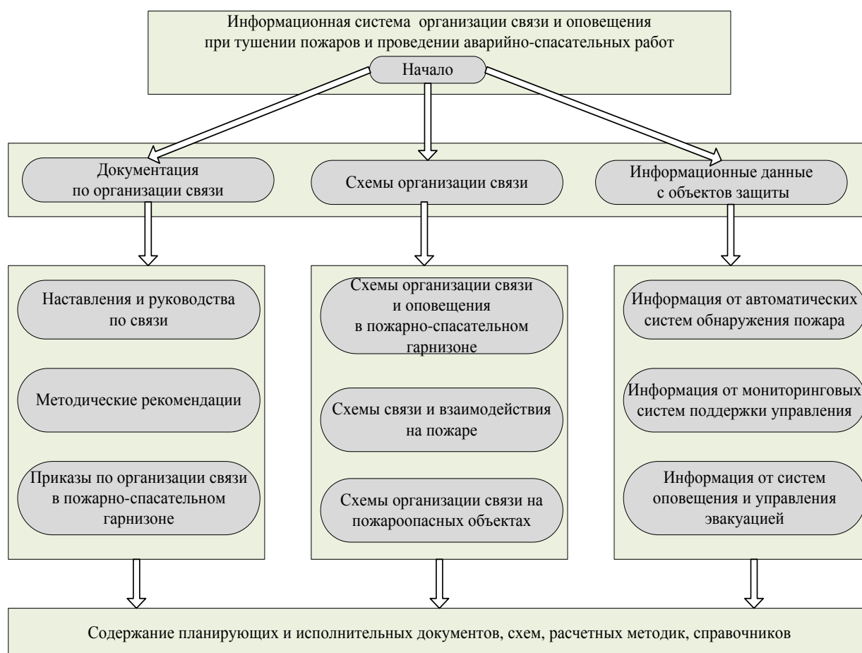
Рис. 2. Структура информационной системы организации связи и оповещения при тушении пожаров и проведении аварийно-спасательных работ
