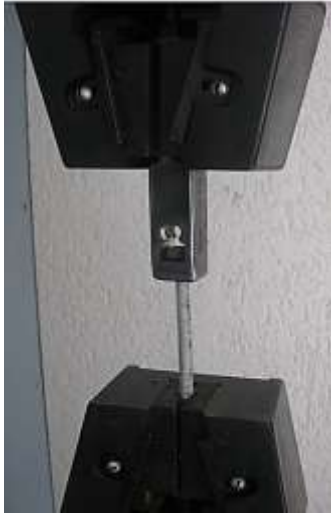
Рис. 2. Приспособление для испытания резьбовых соединений на прочность, закрепленное в губках разрывной машины Р-5
