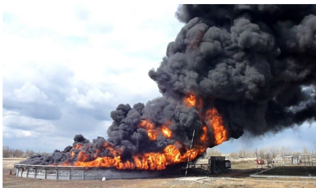
Рис. 1. Горение бензина АИ-92 в макете резервуара РВС-20 000
