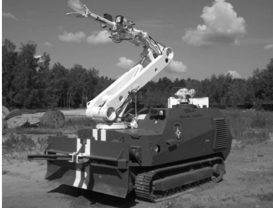
Рис. 1. «Ель-4» — робототехнический комплекс пожаротушения среднего класса
