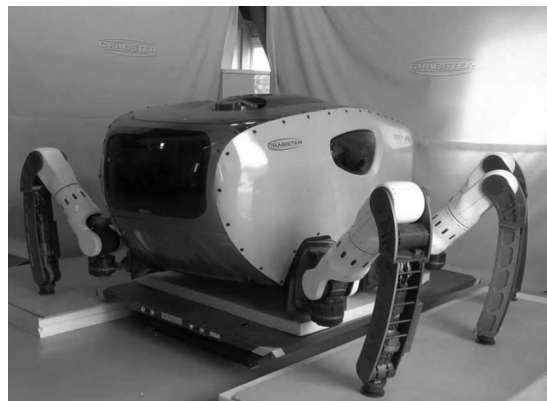
Рис. 3. Глубоководный шагающий робот.
