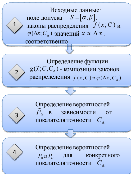
Рис. 1. Блок-схема методики расчета точности измерений при допусковом контроле
