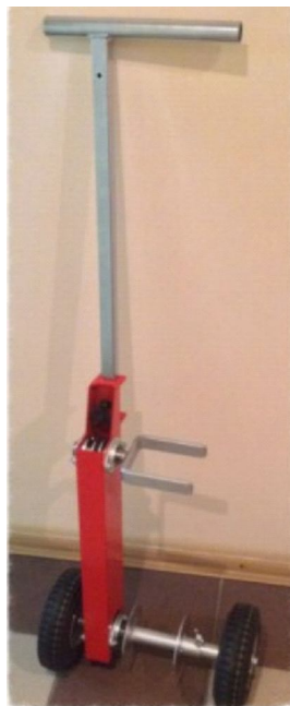
Рис. 2. Устройство №2 для скатки пожарных рукавов от фирмы «Пожарная безопасность»
