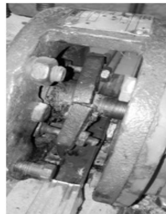
Рис. 1. Нарушение устройства уплотнения в центробежном консольно-моноблочном насосе
