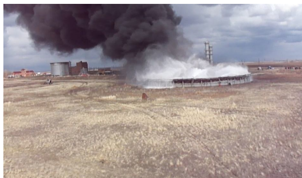
Рис. 2. Тушение макета резервуара РВС-20 000 УИП с подачей СГП
