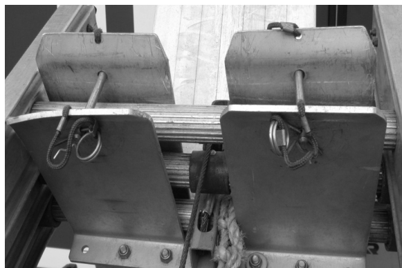
Рис. 9. Верхнее крепление ВПЛ на несущей платформе
