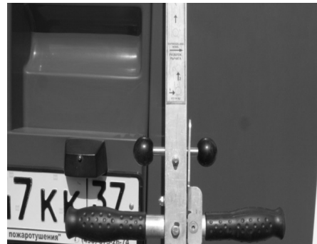
Рис. 4. Расположение фиксаторов на рукоятке
