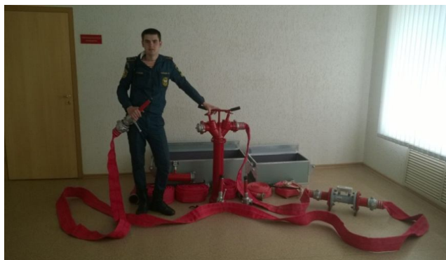
Рис. 4. Комплект измерительных средств с расходомером
