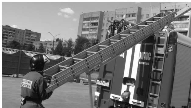
Рис. 12. Опускание лотка с выдвижной пожарной лестницей
