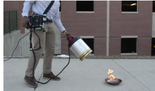
Рис. 2. Портативный прибор для тушения горячей жидкости, основанный на ультразвуковом воздействии
