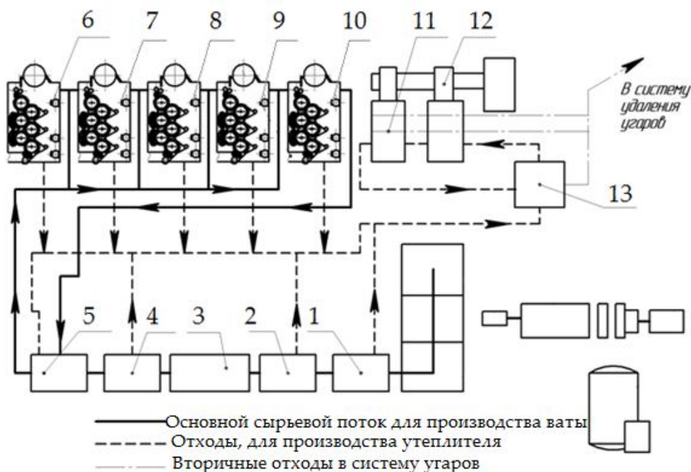
Рис. 1. Технологическая линия для выработки медицинской льносодержащей гигроскопической ваты и утеплителя из отходов этого производства: 1 – питатель, 2 – разрыхлитель-очиститель; 3 – смеситель-накопитель; 4 – наклонный очиститель; 5 – питатель резервный; 6, 7, 8, 9, 10 – основная группа разрыхлительно-чесальных машин РЧВМ с ватными барабанами; 11, 12 – дополнительная группа разрыхлительно-чесальных машин РЧВМ, со слоеформирующим устройством; 13 – питатель огнезащитного состава
