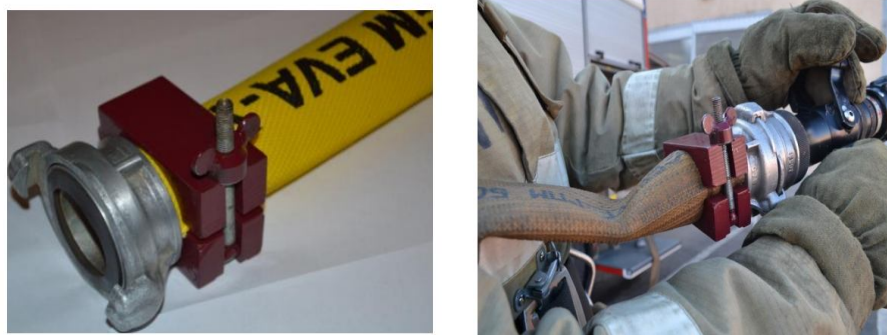
Рис. 2. Конструкционный образец устройства для зажима каркаса напорного рукава на втулке соединительной головки
