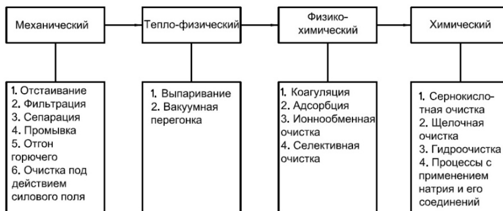
Рис. 2. Методы регенерации отработанного масла
