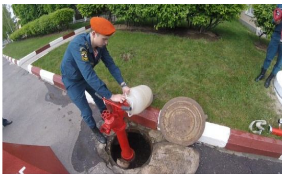
Рис. 1. Определение расхода отношением объема вылившейся жидкости ко времени, за которое наполнился емкость
