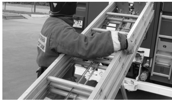
Рис. 15. Снятие ВПЛ с лотка несущей платформы
