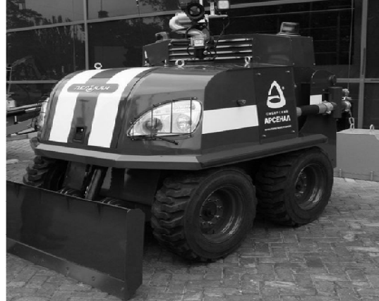
Рис. 2. «Пеликан» - колесный робот для проведения аварийно-спасательных работ и пожаротушения
