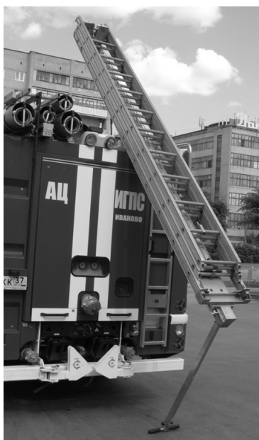
Рис. 7. Платформа опущена и зафиксирована
