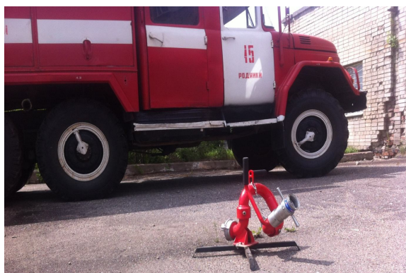
Рис. 1. ЛС-П20У лафетный ствол переносной
