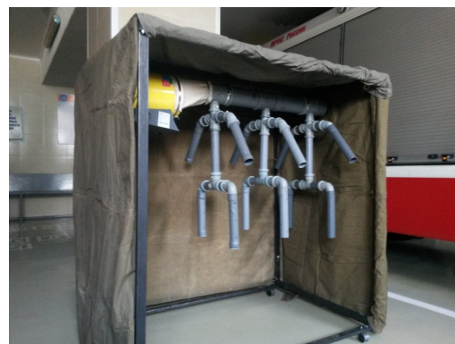
Рис. 3. Сушильная камера для сушки боевой одежды пожарного
