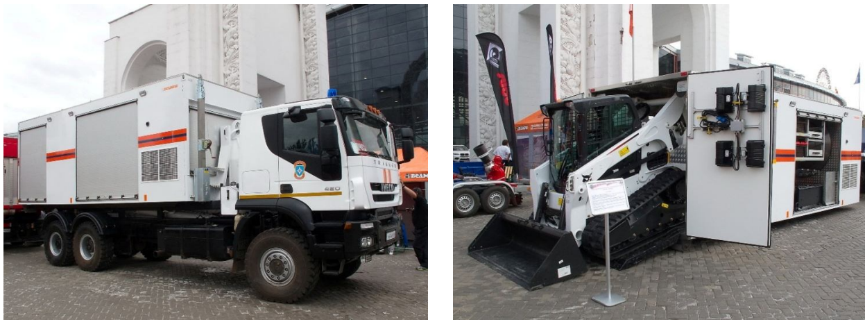
Рис. 1. Мобильный аварийно-спасательный комплекс (МАСК) «Гранит»
