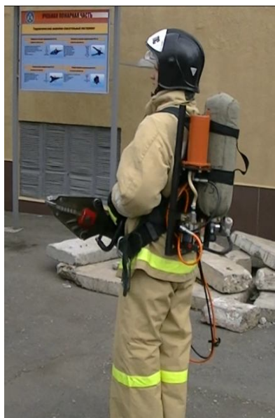
Рис. 2. Пневмогидравлический привод гидравлического аварийно-спасательного инструмента
