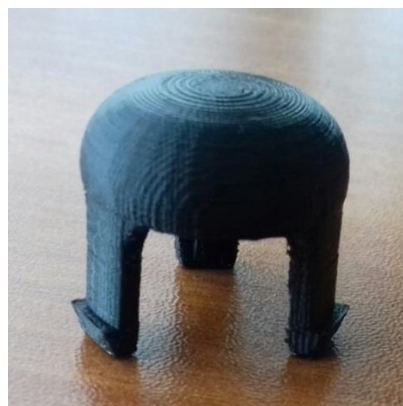
Рис. 5. Фиксатор из PLA пластика (распечатывался «ножками» вниз)
