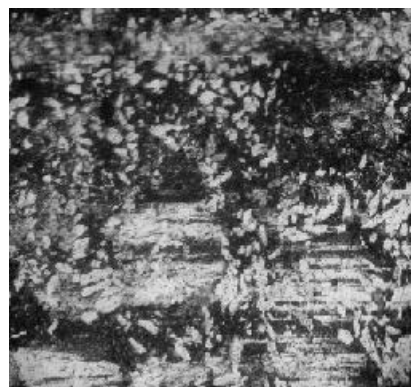
Рис. 6. Поверхность баббитового вкладыша после трения в смазочной композиции содержащей 10 % наполнителя – искусственный серпентин (увеличение x 500)
