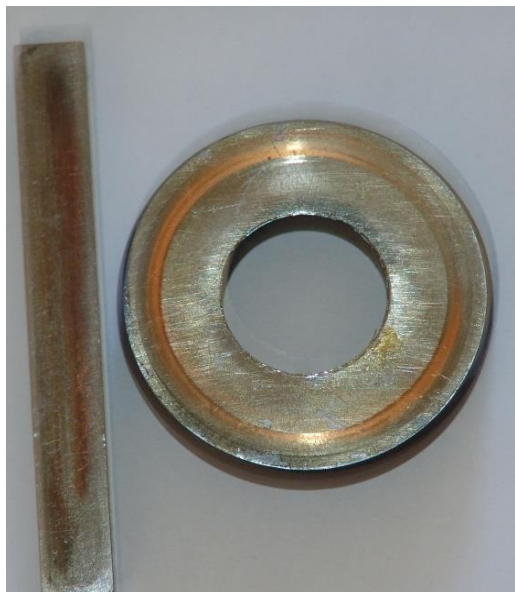
Рис. 1. Внешний вид поверхностей трения образцов возвратно-поступательного и вращательного трения
