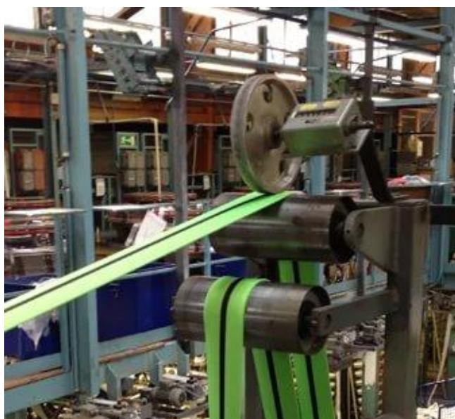
Рис. 3. Стадия производства пожарного рукава «Закатка резиновой прокладки»
