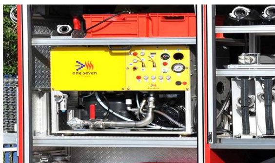
Рис. 2. Установка пенного тушения OS 1200NE в отсеке кузова пожарной автоцистерны АЦ-3,0-40(4308) ООО «Приоритет»
