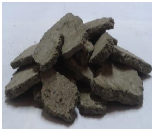
Рис. 1. Форма клинкера, предварительно деформированного в ПВИ
