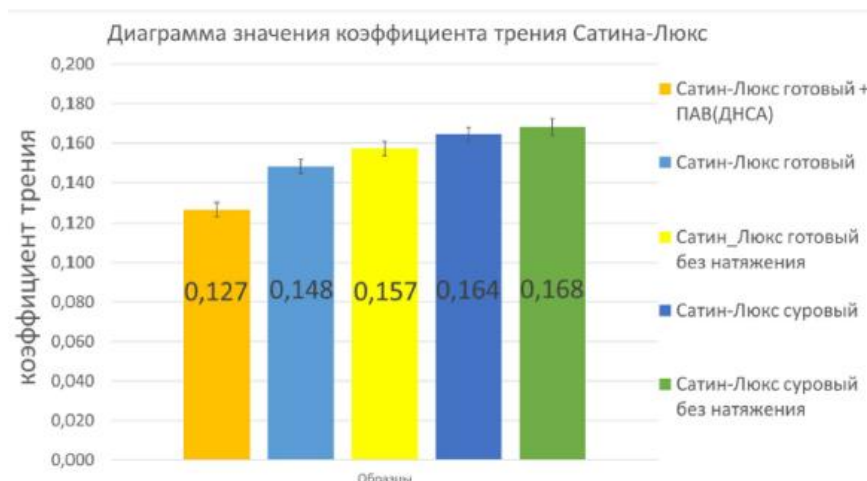
Рис. 2. Влияние натяжения ткани поплин на коэффициент трения различных тканей: а — поплина и б — сатин-Люкс
