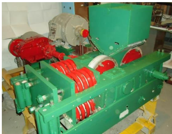
Рис. 1. Экспериментальная установка агрегата для получения кубовидного щебня
