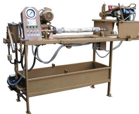
Рис. 4. Установка для испытания пожарных рукавов на стойкость к абразивному износу
