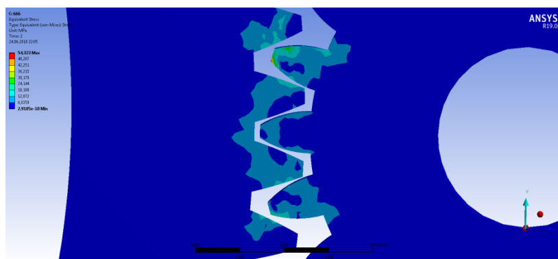
Рис. 4. Распределение напряжений в разрезе зубчатых колес
