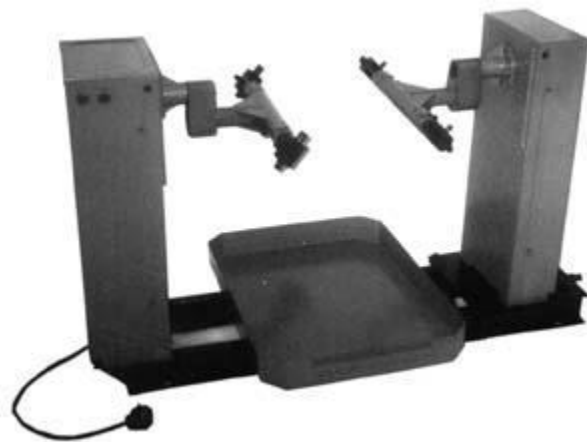
Рис. 1. Станд с электромеханическим приводом поворотного устройства двигателя марки р-660.
