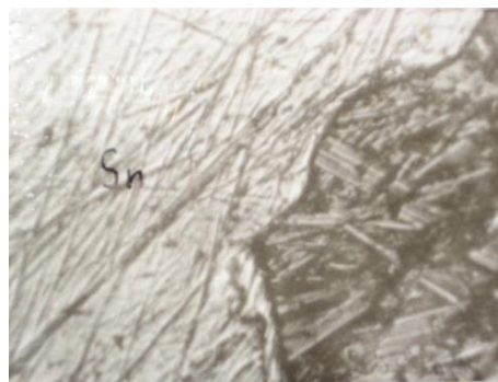
Рис. 6. Внешний вид границы металлоплакирования оловом (X 600)
