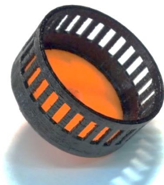
Рис. 2. Фотография оптического колеса датчика, изготовленного при помощи технологии трехмерной печати
