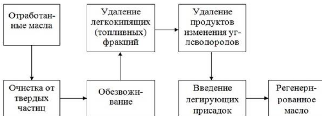
Рисунок. Стадии процесса регенерации отработанных технических масел
