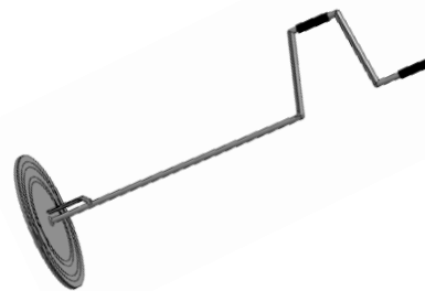
Рис. 4. Трехмерная модель предлагаемого устройства для скатки напорных рукавов
