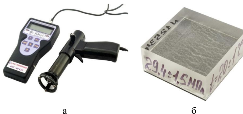
Рисунок. Измеритель прочности бетона ИПС-МГ 4.01 (а) и мера эквивалентной прочности бетона (б)
