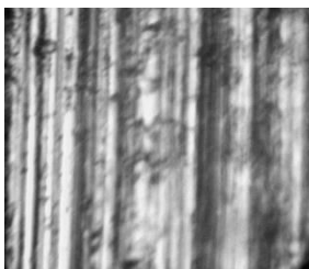
Рис. 4. Фотографии обработки деталей из сталей 40Х, 12Х18Н10Т и дюралюминия Д16 точением (а) и последовательно точением и алмазным выглаживанием (б) на токарном станке с применением состава СОТС[3] (увелич.х1000)
