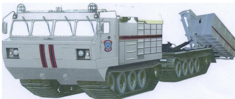
Рис. 2. Аварийно-спасательная машина повышенной проходимости модульного принципа компоновки на базе сочлененного шасси гусеничного транспортера ДТ-10ПМ, завода АО «МК «Витязь»
