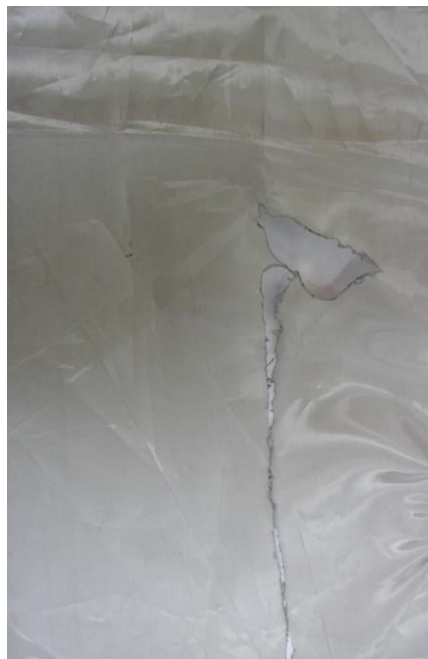
Рис. 5. Внешний вид образца нитрид титана/полиамид после испытания на огнезащитную функцию
