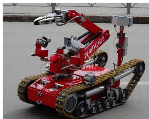
Рис. 2. Мобильный робототехнический комплекс разведки и пожаротушения легкого класса МРК-РП
