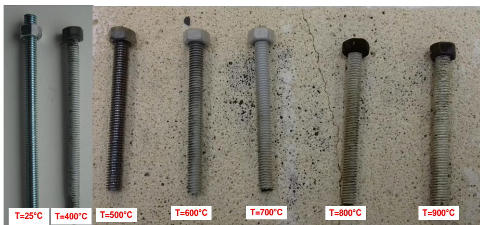
Рис. 3. Резьбовая пара шпилька М8-гайка при различных температурах нагрева
