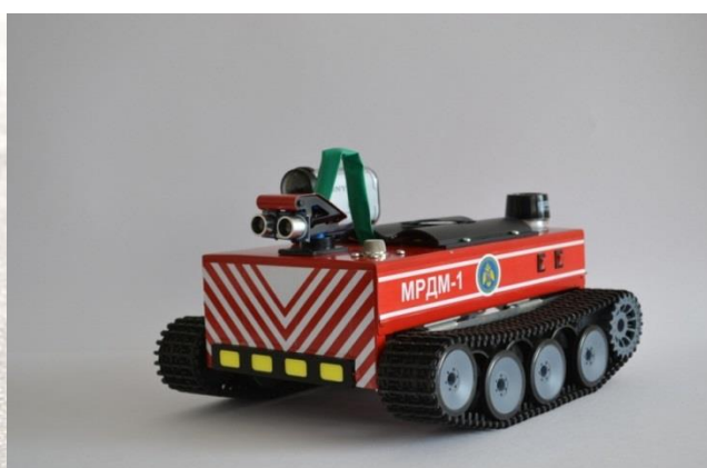
Рис. 2. Модель гусеничного робота МРДМ-1, ИПСА ГПС МЧС России
