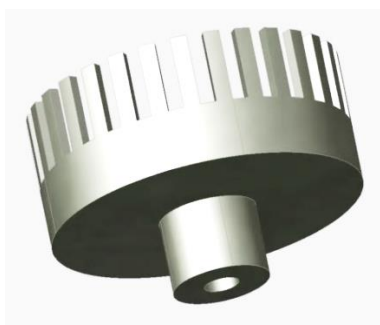
Рис. 1. Трехмерная модель оптического колеса датчика, выполненная в среде AutoCAD
