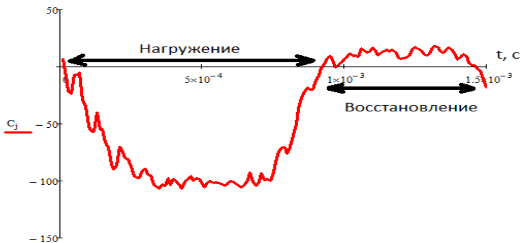
Рис. 4. Взвешивающая функция при хорошем состоянии смазки подшипника
