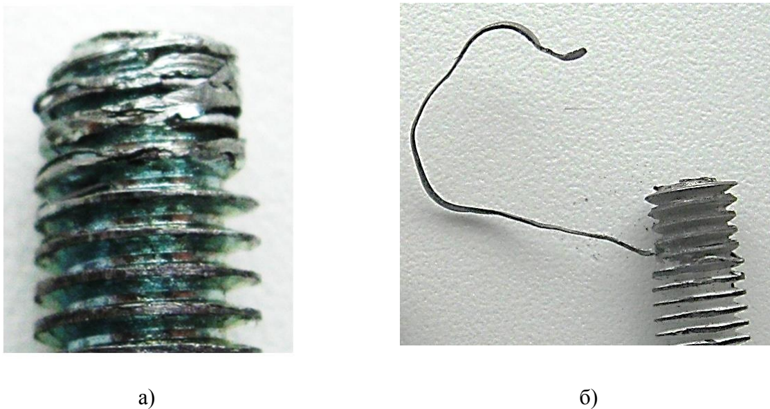
Рис. 6. Шпилька М8 с поврежденными витками:
