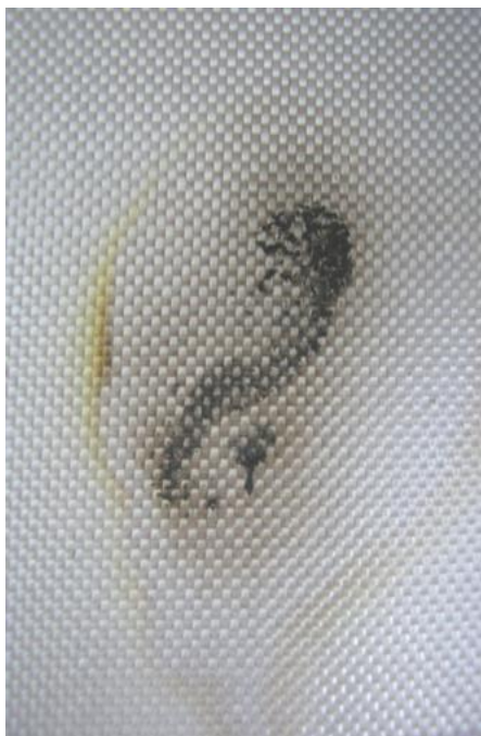
Рис. 4. Внешний вид образца нитрид титана/целлюлоза после испытания на огнезащитную функцию
