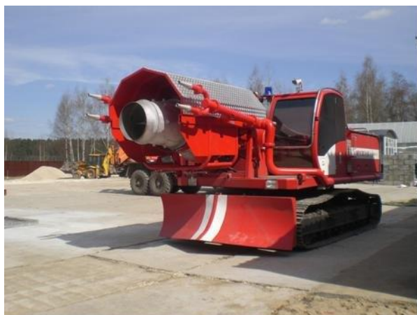
Рис. 6. Мобильный пожарно-спасательный комплекс большой мощности, оснащенный установкой газо-водяного тушения
