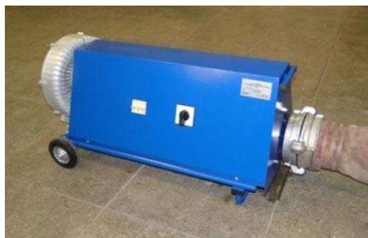
Рис. 1. Устройство для конвективной сушки напорных пожарных рукавов
