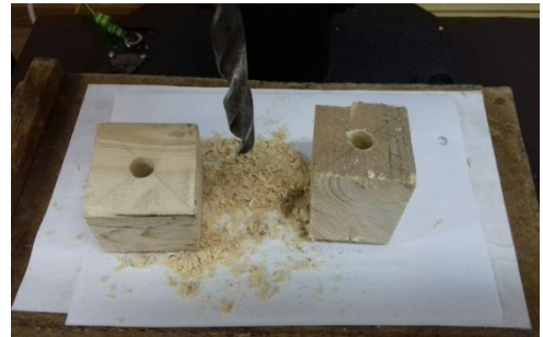
Рис. 1. Сверление образцов вдоль и поперек волокон
