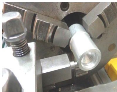
Рис. 3. Фотография обработки детали алмазным выглаживанием на токарном станке
