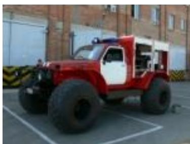
Рис. 6. Мобильный пожарно-спасательный комплекс большой мощности, оснащенный установкой газо-водяного тушения
