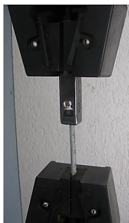
Рис. 2. Приспособление для испытания резьбовых соединений на прочность, закрепленное в губках разрывной машины Р-5
