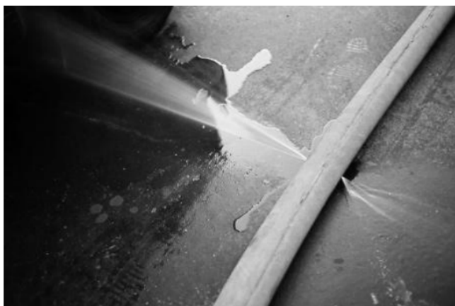
Рис. 3. Прорыв напорного пожарного рукава
