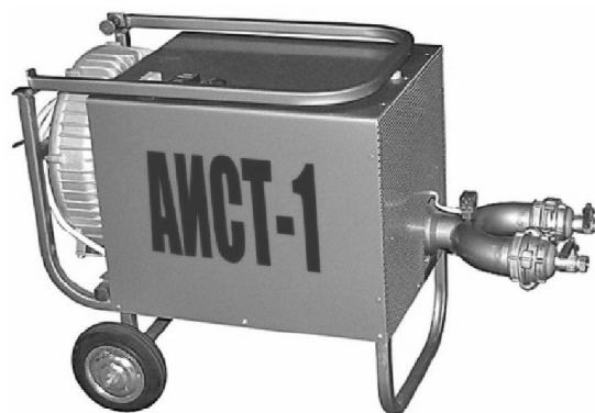
Рис. 2. Аппарат испытания сушки и талькирования рукавов
