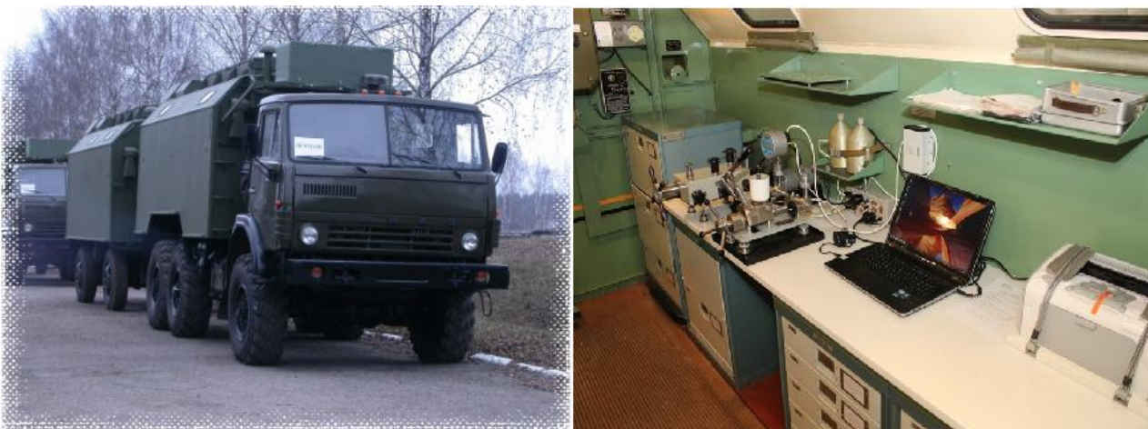
Рис. 2. Подвижная лаборатория измерительной техники ПЛИТ-АЗ-2
