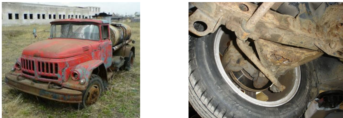
Рис. 1. Коррозия металлических деталей автомобиля
