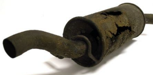
Рис. 2. Резонатор автомобиля, разрушенный вследствие газовой коррозии
