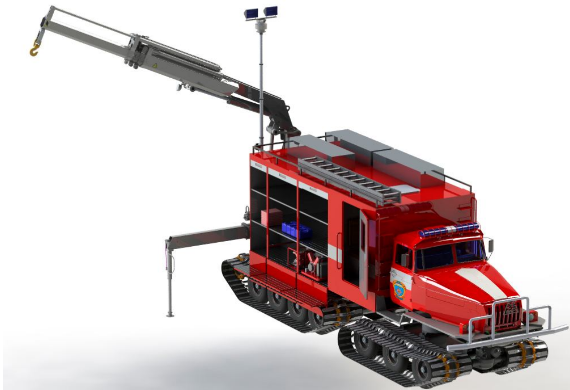
Рис. 3. Макетный образец аварийно-спасательной машины АСМ-20-06 на двухзвенном 4-гусеничном шасси с гидроманипулятором
