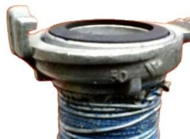
Рис. 1. Скол запорных выступов соединительной головки пожарного рукава
