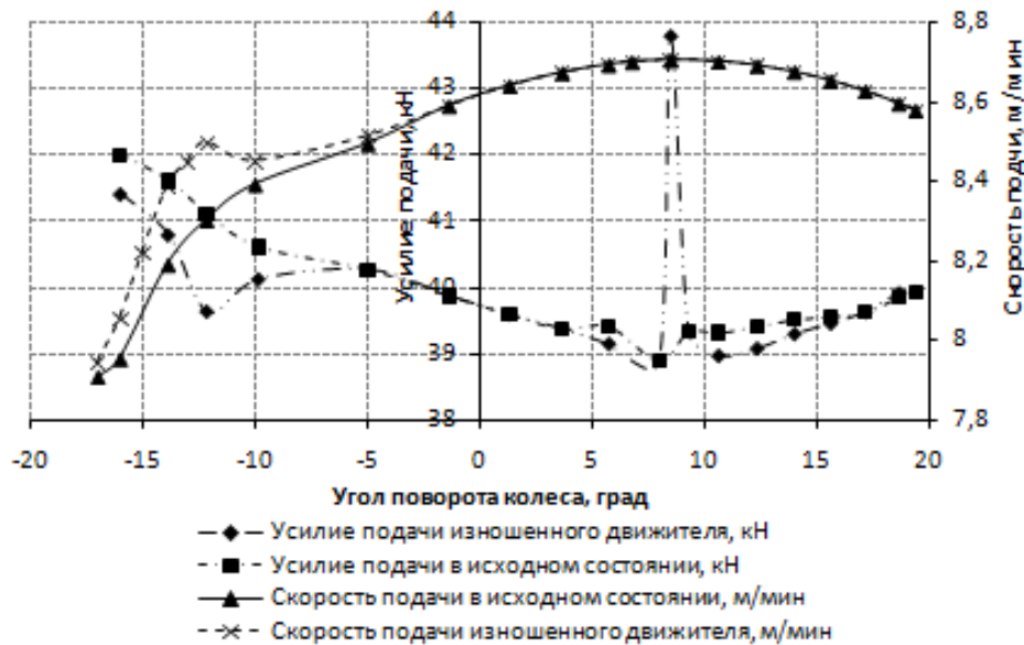
Рис.1. Изменение усилия подачи и скорости подачи в исходном и изношенном состоянии для двухэлементного двигателя с зубчатой рейкой
