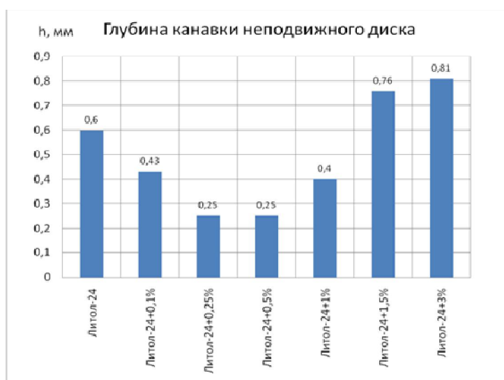
Рис. 1. Величина износа в узле трения
