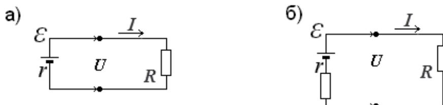
**Рис. 1.** а) простейшая схема замкнутой цепи и б) её модель с источником постоянной ЭДС без внутреннего сопротивления и последовательно включенного постоянного внутреннего сопротивления  $r$
