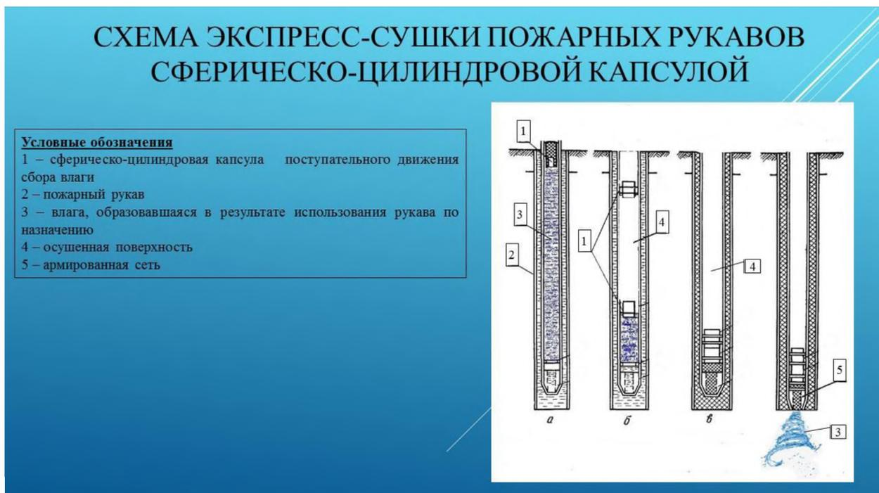
Рис. 2. Схема экспресс-сушки пожарных рукавов сферическо-цилиндрической капсулой
