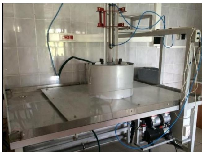
Рис. 1. Общий вид лабораторного стенда с модельным резервуаром и защитной стенкой
