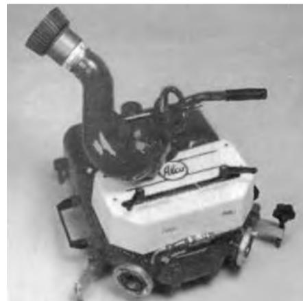
**Рис. 1.** Гидромонитор осциллирующий переносной
