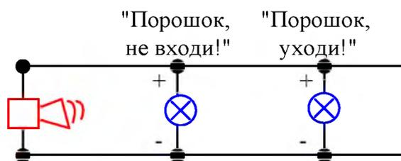
**Рис. 7.** Схема подключения сигнального оборудования
