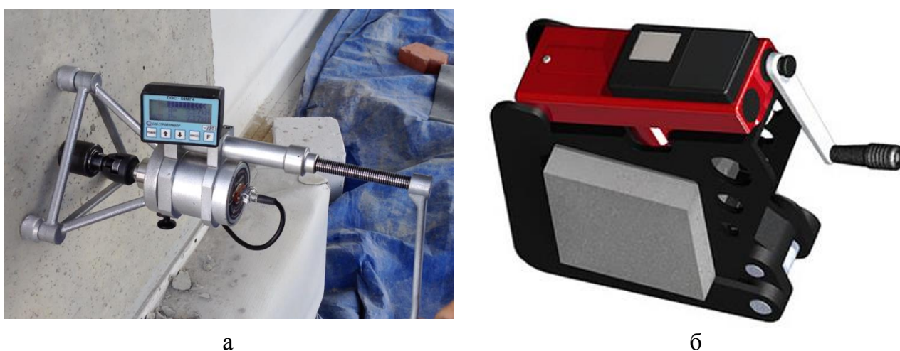
Рис. 3. Прибор для испытания бетона методом отрыва со скалыванием (а) и отрыва со скалыванием ребра (б)
