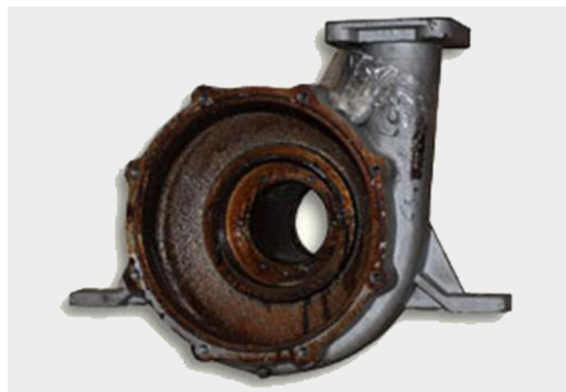
Рис. 2. Результат износа рабочей полости центробежного насоса
