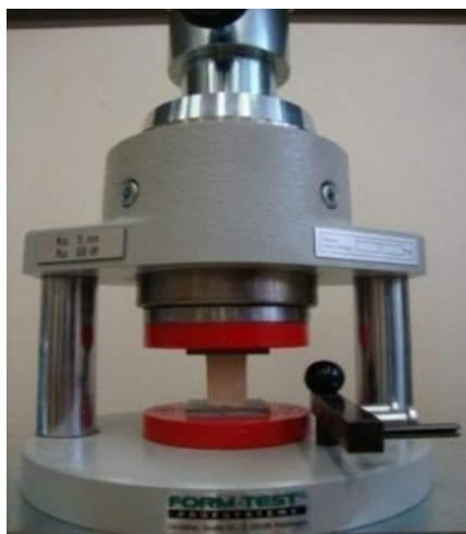
Рис. 4. Определения предела прочности древесины (а) и на изгиб (б)
