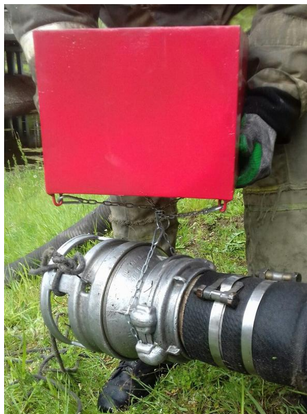
Рис. 4. Опытная модель плавающего устройства для всасывающих сеток
