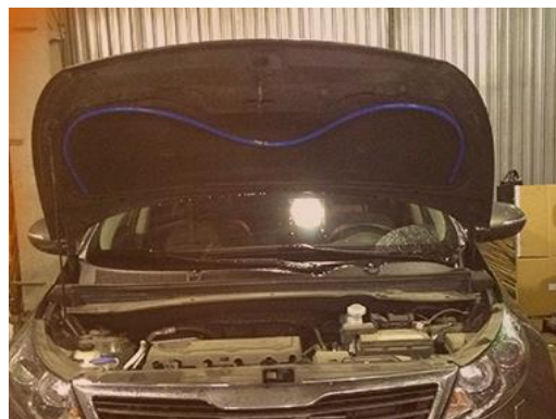
Рис. 5. Установка пожаротушения «Подкова»
