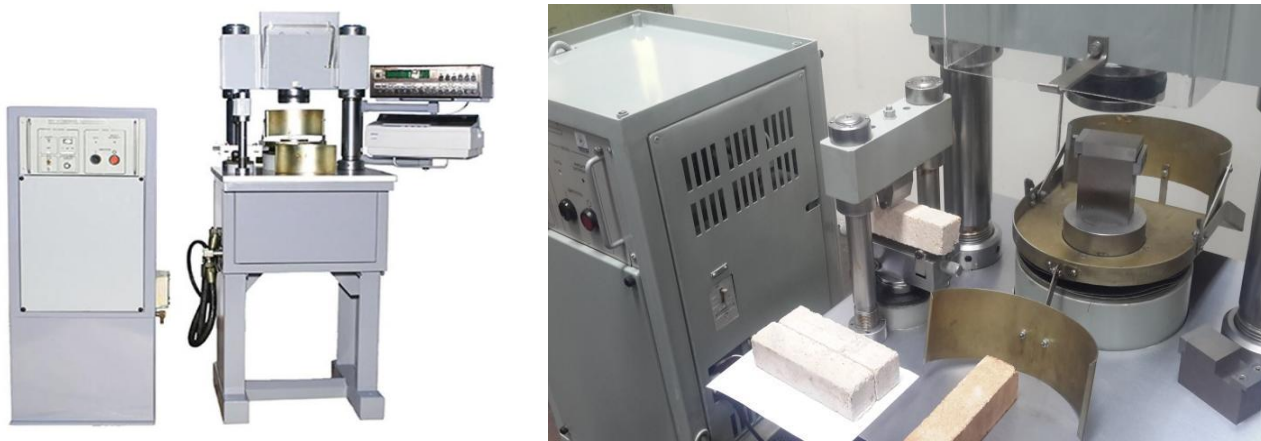
Рис. 2. Испытательная машина образцов-балочек на изгиб и сжатие
