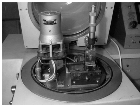
Рис. 1. Внешний вид (а) и схема установки (б) для резания в контролируемой атмосфере
