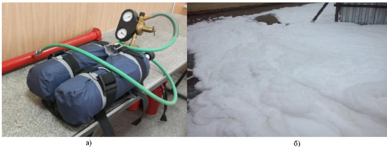
Рис. 1. Встраиваемая установка для получения компрессионной пены: а) общий вид установки; б) получаемая компрессионная пена средней кратности
