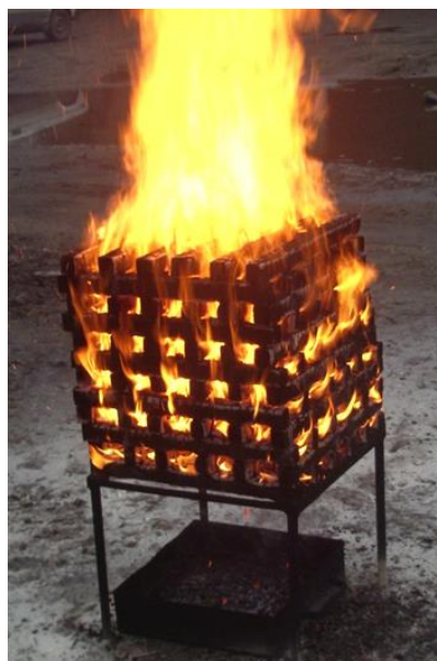
Рис. 1. Модельный очаг пожара класса 1А (штабель брусков из древесины)
