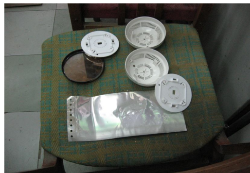
Рисунок. Вид подготовленной поверхности дымового пожарного извещателя ИП 212-02М1 перед нанесением покрытия
