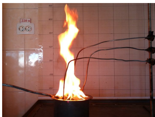
Рис. 4. Горение на подложке Ф 20–30
