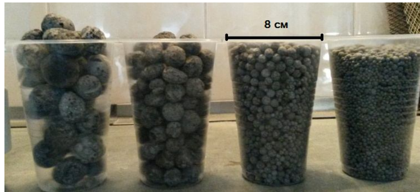
Рис. 1. Образцы гранулированного пеностекла различных фракций (слева направо Ф–20–30 мм, Ф–10–20 мм, Ф–5–7 мм, Ф–1–5 мм)
