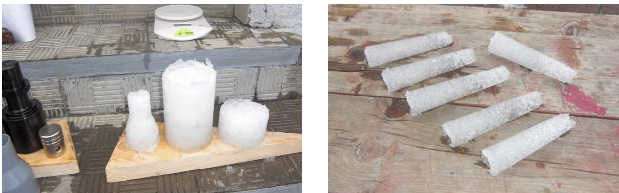
Рис. 1. Образцы брикетов из снежной массы
