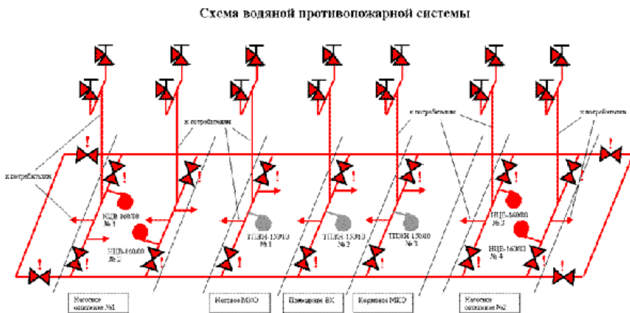
Рис. 1. Схема водяной противопожарной системы
