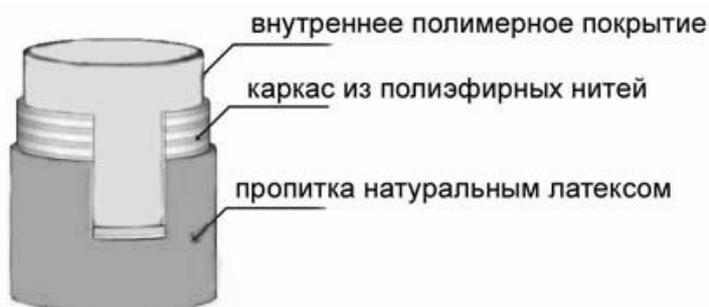
**Рис. 1.** Структура напорного пожарного рукава
