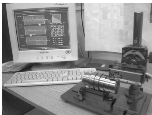
**Рис. 1.** Внешний вид профилографа-профилометра, способ исследования образца
