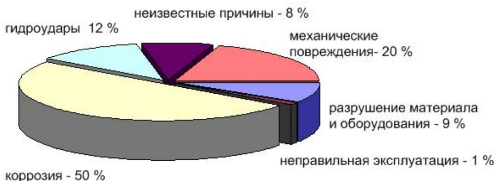
**Рис. 1.** Распределение общего числа разрушений трубопроводов в зависимости от вызвавших их причин
