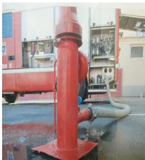
**Рис. 4.** Испытание пожарной колонки
