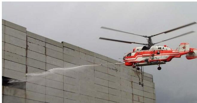
Ка-32А11ВС отличается простотой и точностью управления, достигаемых за счет использования соосной схемы расположения несущих винтов. Отсутствие рулевого винта и сокращение длины хвостовой балки до габаритов несущих винтов облегчает маневрирование вблизи препятствий и позволяет добиться исключительной точности висения даже при работе в зоне пожара и в условиях нестабильной атмосферы. Высокая энерговооруженность позволяет перевозить до 5 тонн воды.
