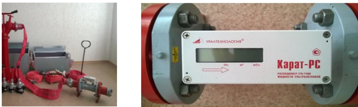
Рис. 1. Устройство по определению водоотдачи пожарного гидранта
