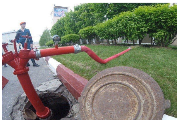
Рис. 3. Метод определения расхода с помощью показания манометра
