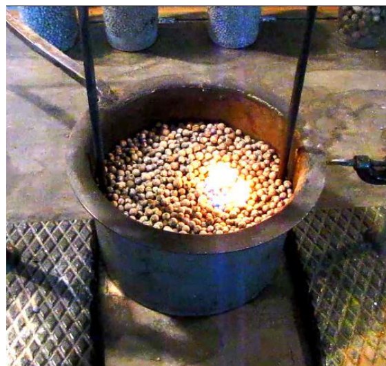
Рис. 7. Горение пролива бензина АИ-92 на гранулированной пеностекляной подложке в модельном очаге d=15\text{ см}^2
