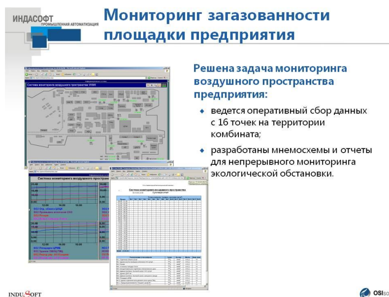
Рис. 1. Пример мнемосхемы мониторинга загазованности промышленной площадки
