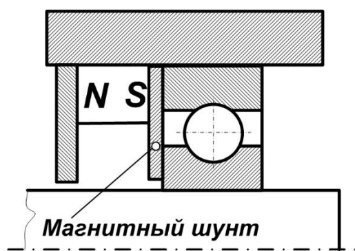
Рис. 3.13. К расчету магнитного поля в подшипнике качения: а – картина магнитного поля, б, в – распределение магнитной индукции на вершине тела качения и в рабочем зазоре, г – положение магнитного шунта
