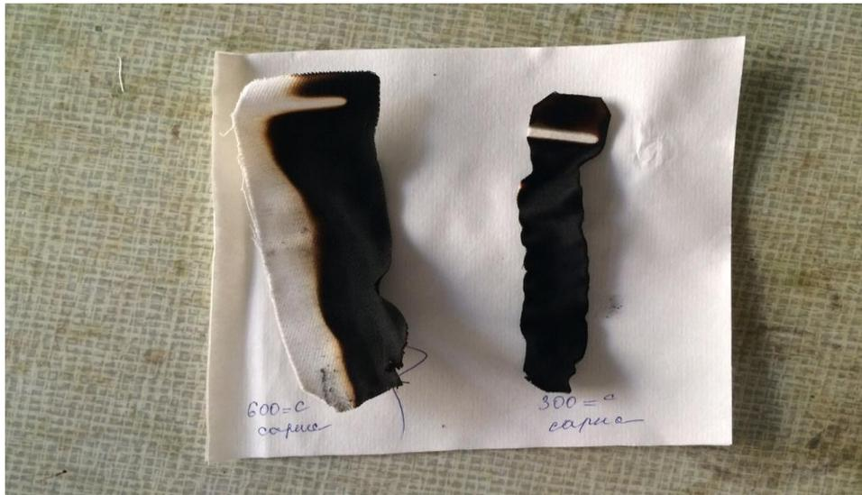
**Рис. 6.** Фотография образцов саржи после испытаний по ГОСТ Р ИСО 10528-99
