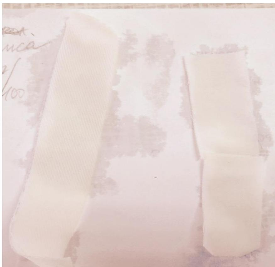
**Рис. 9.** Фотография образцов отбеленной саржи после мокрой обработки
