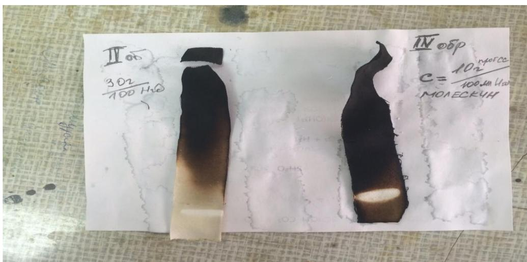
**Рис. 7.** Фотография образцов молескина после испытаний по ГОСТ Р ИСО 10528-99
