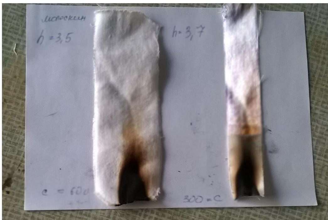
**Рис. 10.** Фотография образцов отбеленного молескина после мокрой обработки по ГОСТ Р ИСО 10528-99 и испытания огнезащитных свойств образцов ГОСТ 11209-85
