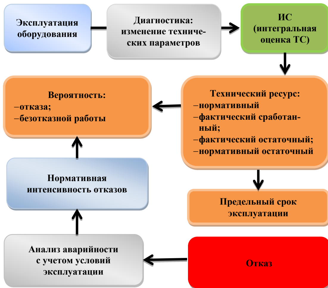
Рис. 4.1.1. Блок-схема определения технического ресурса, предельного срока эксплуатации, вероятностей безотказной работы и отказа оборудования
