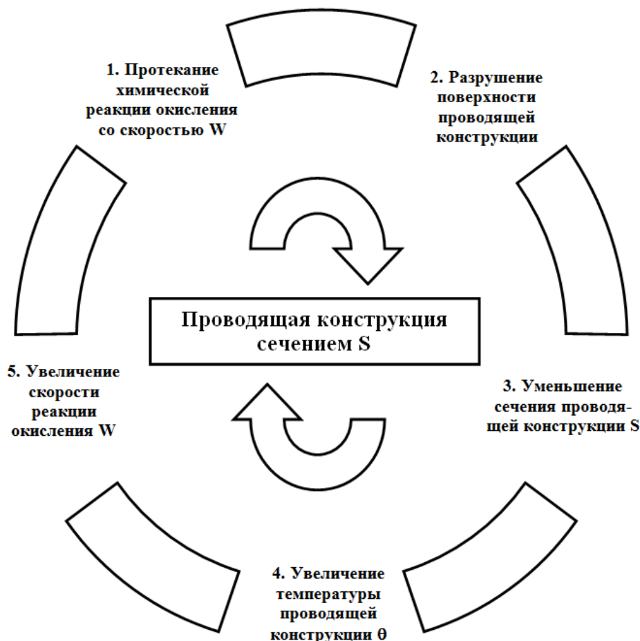
Рис. 3.5.4. Схема циклического процесса сработки ресурса проводящих конструкций
