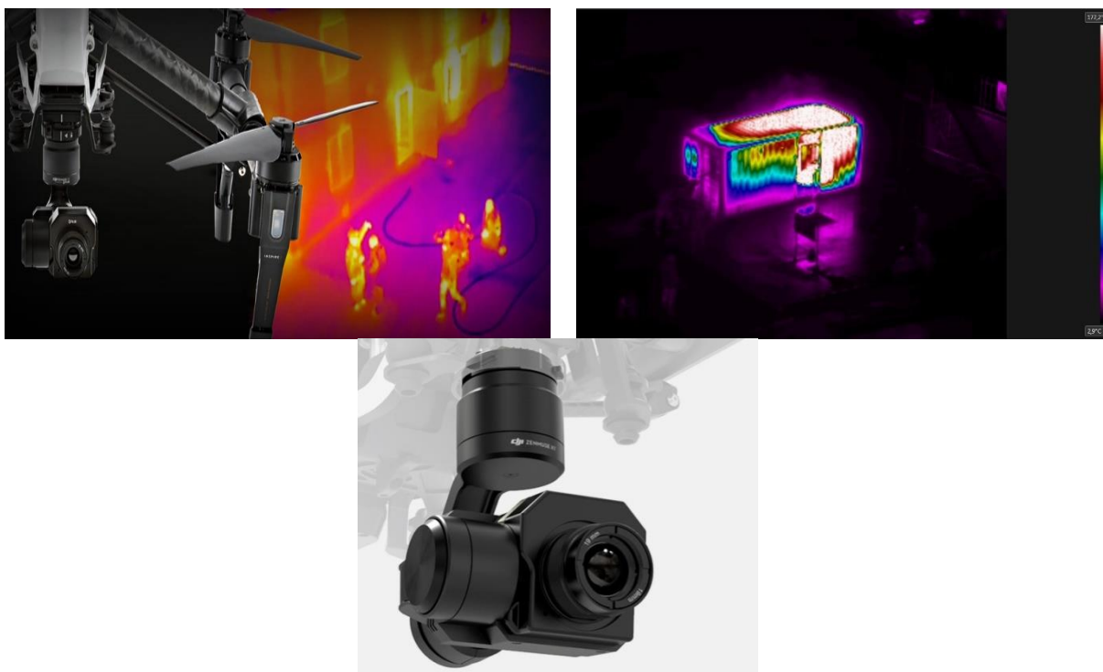
Рис. 1.11. Инфракрасное оборудование на БАС «DJI Inspire 1»
