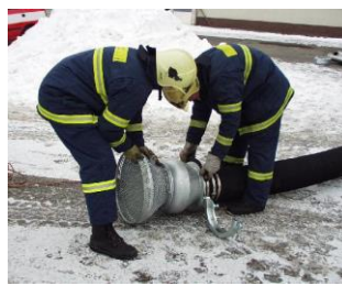
Рис. 2. Нарращивание всасывающей линии насосного модуля MSC SIGMA 20-1500
