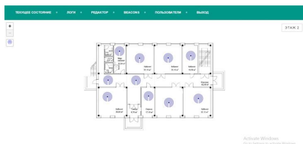
Рис. 6. Схема размещения приемники iBeacon на плане здания
