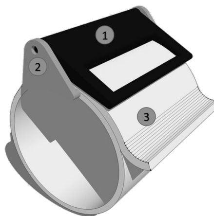
Рисунок. Разработанное устройство в сборе: 1 – рукоятка, 2 – корпус, 3 – текстильный материал
