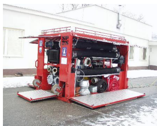
Рис. 2. Нарращивание всасывающей линии насосного модуля MSC SIGMA 20-1500
