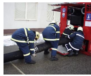
Рис. 2. Нарращивание всасывающей линии насосного модуля MSC SIGMA 20-1500
