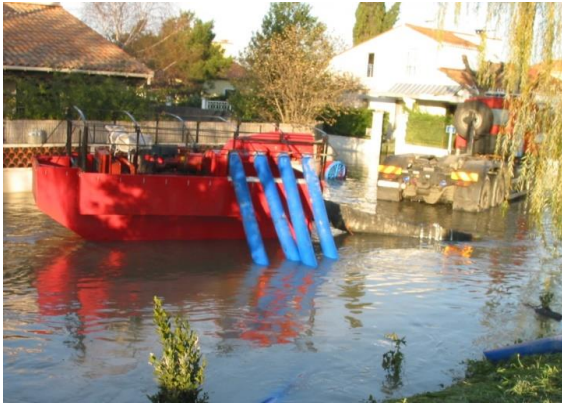
Рис. 3. Варианты исполнения насосных модулей SIGMA и процесс их работы
