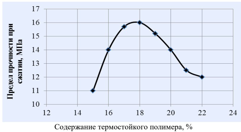
Рис. 2. Предел прочности образцов при сжатии, МПа Приведенный полином: Y=12,5+0,5z1+2,1z2-2,5z3
