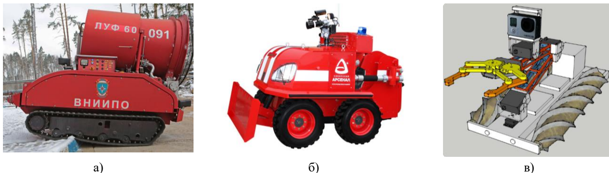
Рис. 1. Пожарные роботы с различными двигателями: а- гусеничный беспилотный пожарный робот LUF 60; б - колесный пожарный робот «Пеликан»; в- Шнекороторное роботизированное устройство с манипулятором
