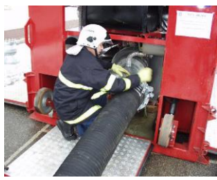
Рис. 2. Нарращивание всасывающей линии насосного модуля MSC SIGMA 20-1500
