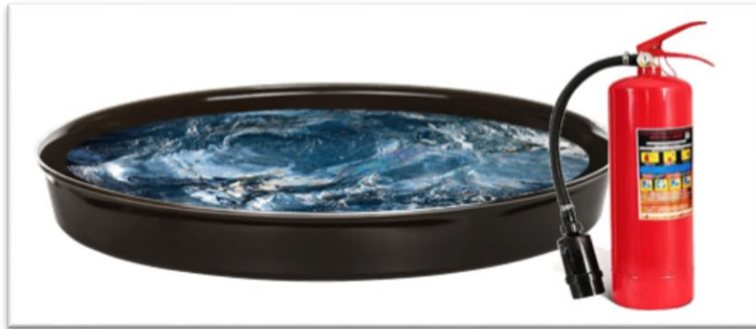
Рисунок 2 - Подготовка к проведению испытания огнетушителя на модельный очаг пожара класса В.
