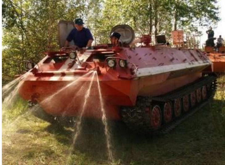
Рисунок 4 - Гусеничная пожарная машина ГПМ-10
