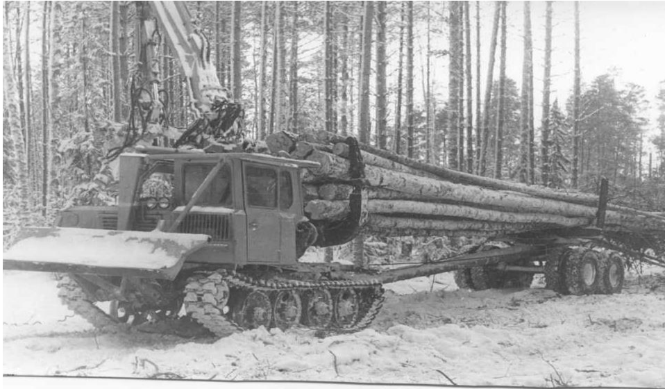
Рисунок 2 - Валочно-трелевочная машина ЛП-17А Трелевка деревьев в полупогруженном положении.
