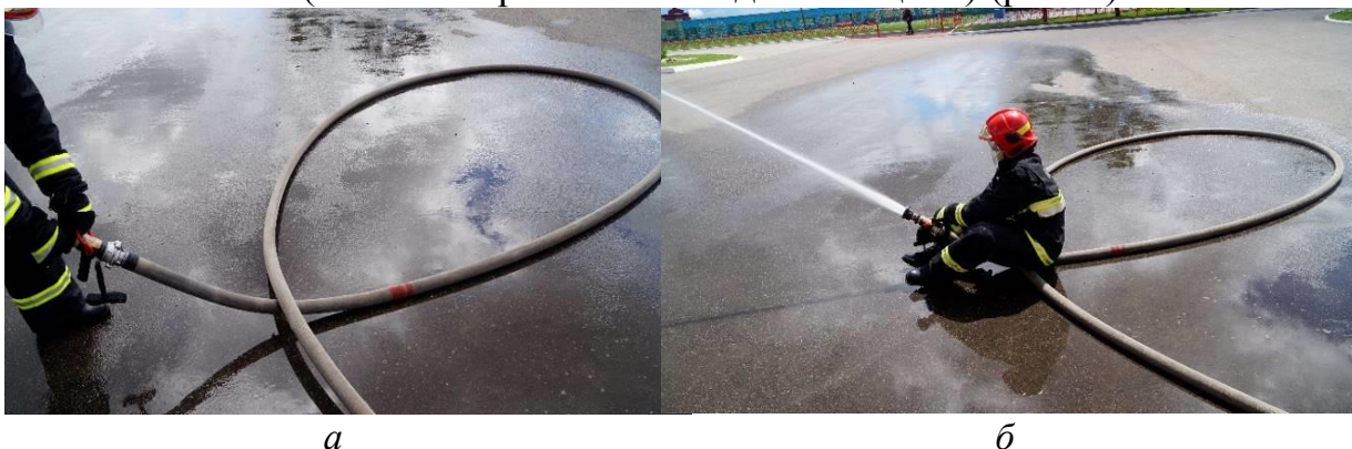
Рисунок 2 – Фиксация ствола при помощи рукавной линии и ствольщика: а – фиксация ствола рукавной линией; б – работа ствольщика с зафиксированным стволом
