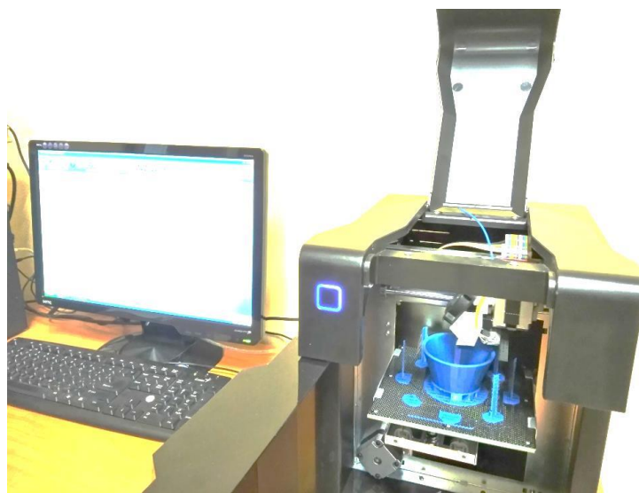
Рисунок 2 - Процесс изготовления насадки для газоанализатора «Колион-1В»
