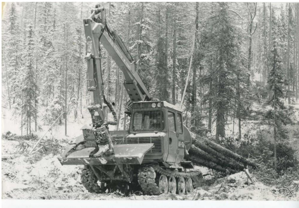
Рисунок 3 - Валочно-транспортная машина ЛП-17А Транспортирование деревьев в погруженном положении.
