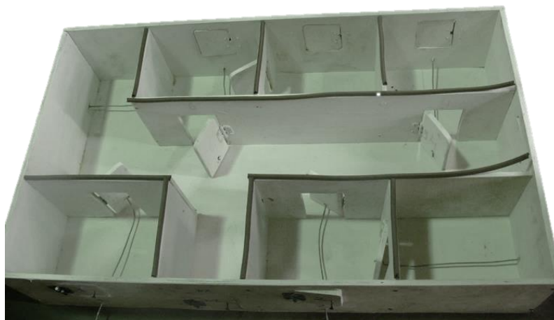
Рисунок 2 - Пример лабораторной установки тактической вентиляции
