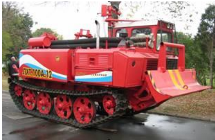
Рисунок 2 - Пожарная машина на гусеничном шасси ЛХТ-100А-12
