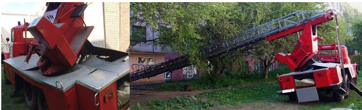
Рисунок 2 - Авария пожарной автолестницы АЛ-30(131) произошедшая в ходе проведения аварийно – спасательных работ в г. Магнитогорск
