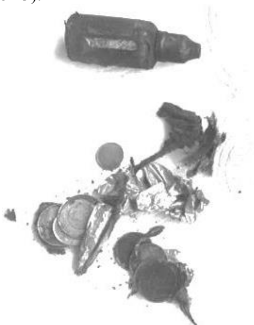
Рисунок 3 - Результат аварийного режима работы контактных элементов корпуса
