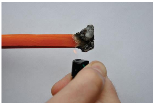
Рисунок 3 - При огневом воздействии образуется пенно-коксый слой, препятствующий горению древесины.
