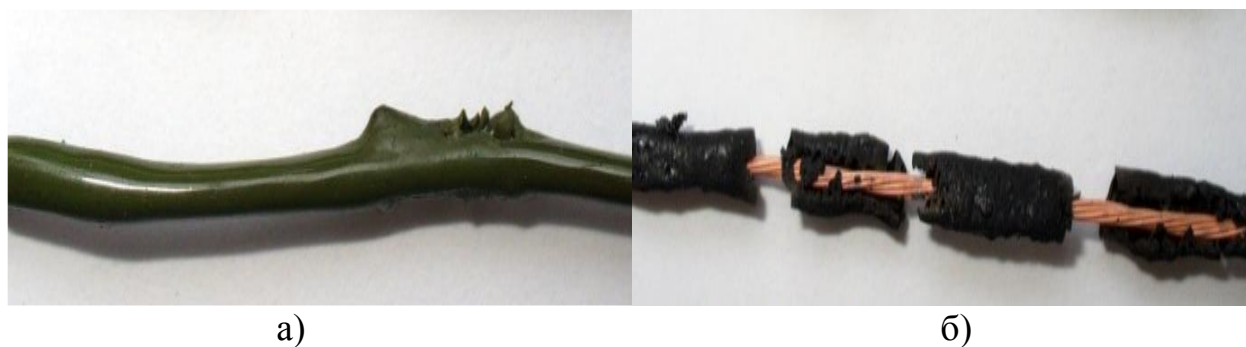
Рисунок 4 – Внешний вид медных проводов, при разной температуре нагрева: а) – 200 0 С; б) – 300 0 С
