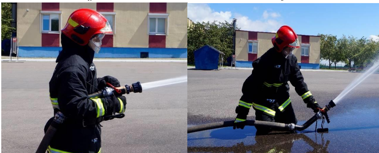
Рисунок 6 – Подача ствола с усовершенствованным входным крепежом: а – перемещение с рукавной линией и стволом; б, в, г – варианты работы со стволом с использованием входного крепежа
