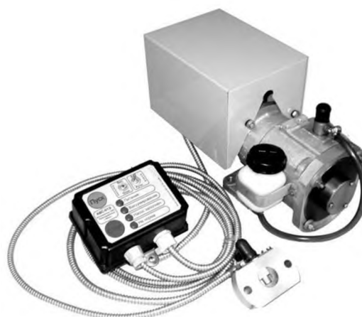
Рис. 1. Вакуумная система центробежных насосов
