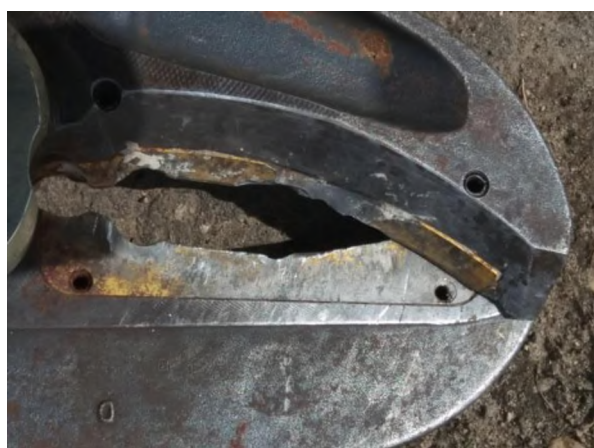
Рис. 1. Износ режущей кромки гидравлических кусачек (Вид дефекта: скол режущей части)
