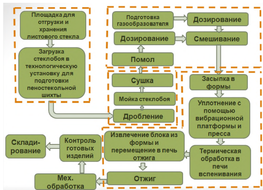
Рис. 1. Технологическая схема производства пеностекла
