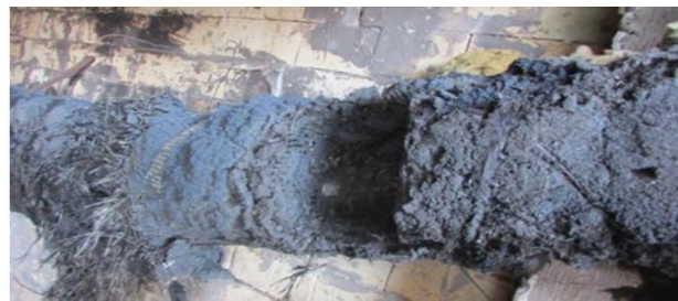
Рис. 3. Результат огневого испытания образца, выдержавшего 60-минутное испытание в печи при температуре 1000 °С
