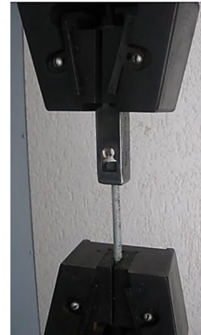
Рис. 1. Приспособление для испытания резьбовых соединений на прочность, закрепленное в губках разрывной машины Р-5
