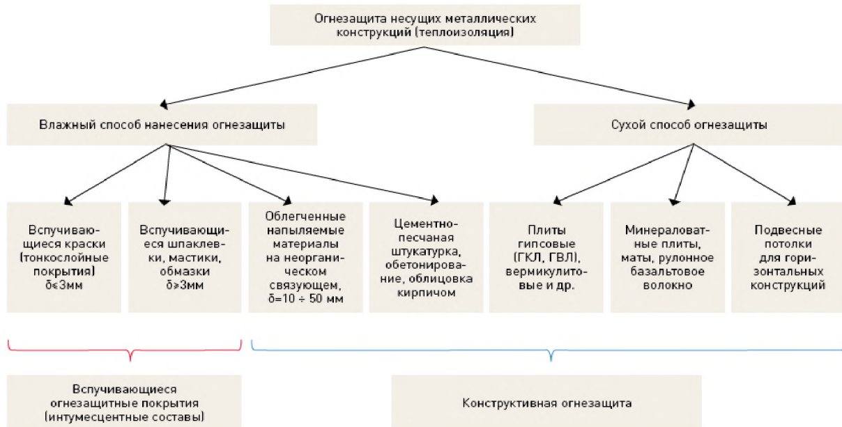
Рис. 1. Классификация средств огнезащиты по способу нанесения и типу материала согласно [8]
