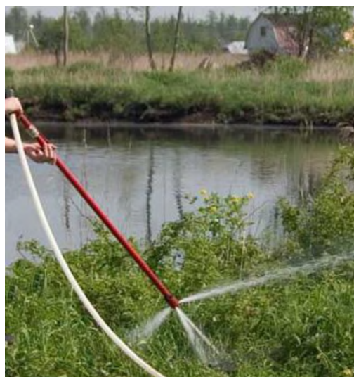
Рис. 8. Сопловой наконечник «Гидробура» формирует мощную иглообразную струю воды
