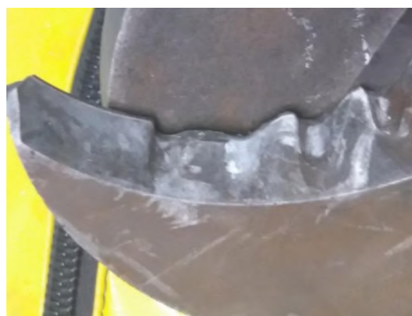
Рис. 2. Износ режущей части гидравлических кусачек (Вид дефекта: скол режущей части)
