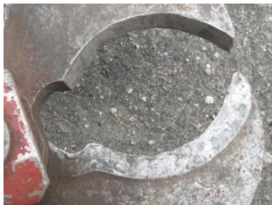
Рис. 3. Гидравлический труборез марки «Спрут» (Смятие режущих кромок)
