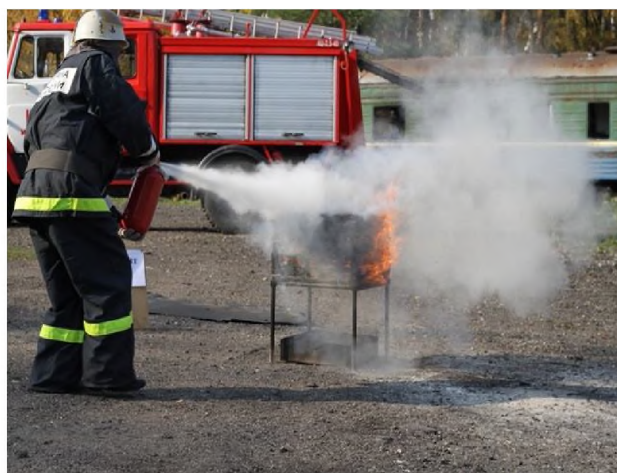
Рис. 2. Полигонные испытания огнетушащих порошковых составов: а – тушение ЛВЖ; б – тушение штабеля древесины
