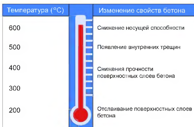
Рис. 2. Изменение свойств бетона при повышении температуры внешнего воздействия
