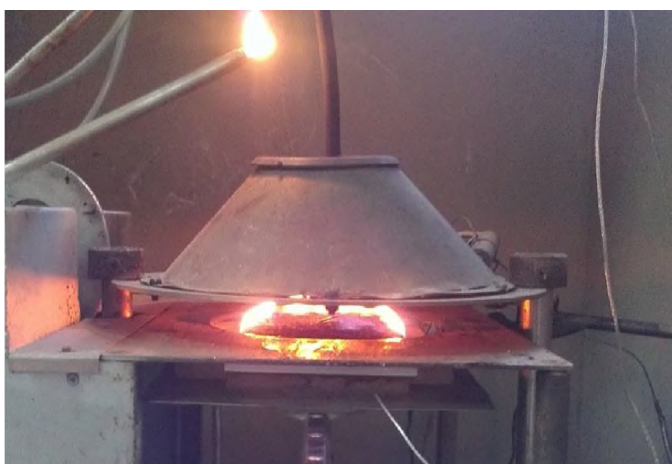
Рис. 3. Общий вид испытаний по оценке воспламеняемости
