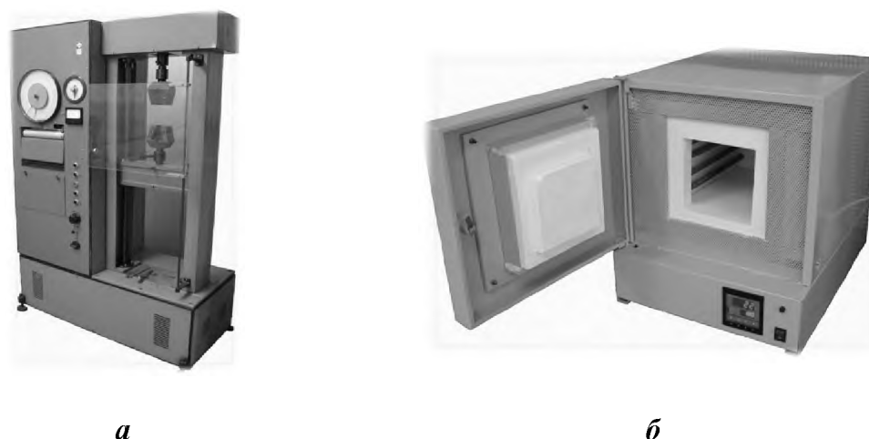
Рис. 1. Лабораторное оборудование: а – разрывная машина Р-5; б – муфельная печь
