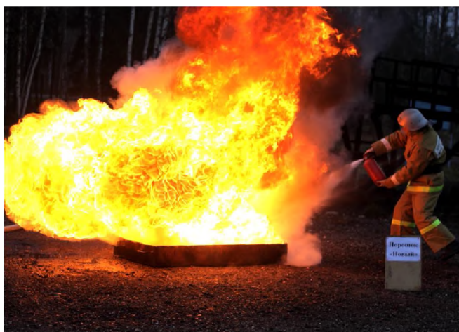
Рис. 2. Полигонные испытания огнетушащих порошковых составов: а – тушение ЛВЖ; б – тушение штабеля древесины
