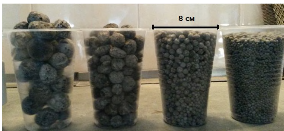
Рис. 1. Образцы гранулированного пеностекла различных фракций (слева направо \Phi –20-30 мм, \Phi -10–20 мм, \Phi -5–7 мм, \Phi -1–5 мм)
