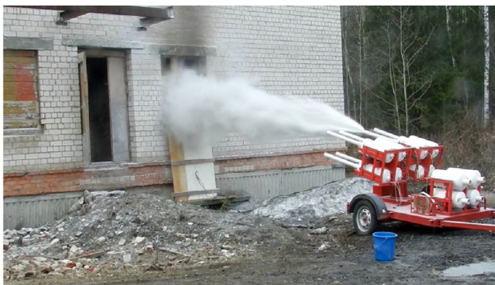
Рис. 3. Полигонные испытания установки «Мобильный комплекс порошкового пожаротушения «Гранит»»
