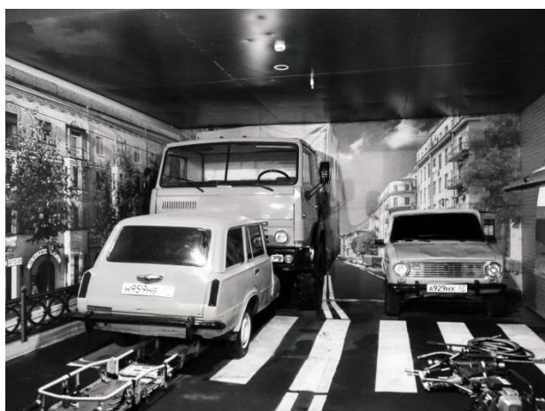
Рис. 2. Изображение модуля 1, имитирующего лобовое столкновение и наезд автотранспортного средства КАМАЗ на автотранспортное средство ВАЗ и модуля 2, имитирующего лобовое столкновение автотранспортного средства ВАЗ и пешехода с велосипедом, модуля 3, имитирующего возгорание автотранспортного средства «Таврия» вследствие замыкания проводки
