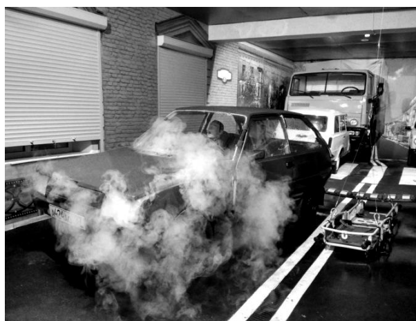
Рис. 2. Изображение модуля 1, имитирующего лобовое столкновение и наезд автотранспортного средства КАМАЗ на автотранспортное средство ВАЗ и модуля 2, имитирующего лобовое столкновение автотранспортного средства ВАЗ и пешехода с велосипедом, модуля 3, имитирующего возгорание автотранспортного средства «Таврия» вследствие замыкания проводки
