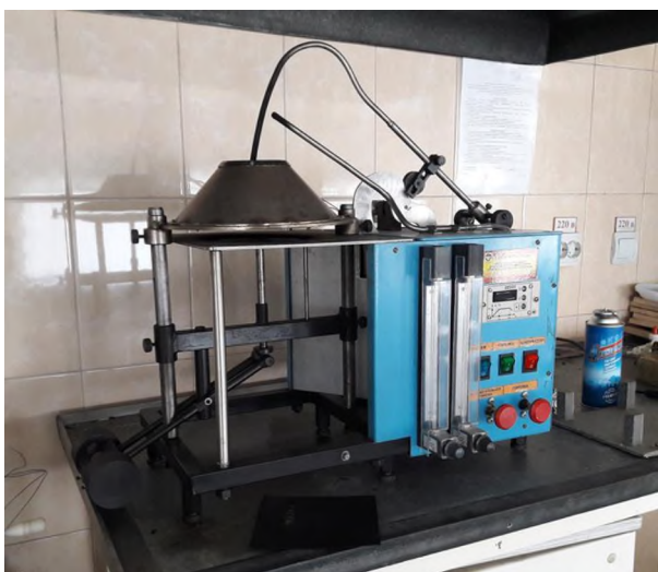
Рис. 3. Испытательная установка для определения воспламеняемости
