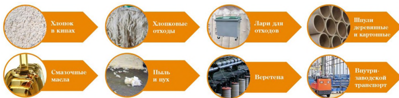
Рис. 2. Производственные факторы, способствующие возникновению пожаров и загораний на текстильных предприятиях
