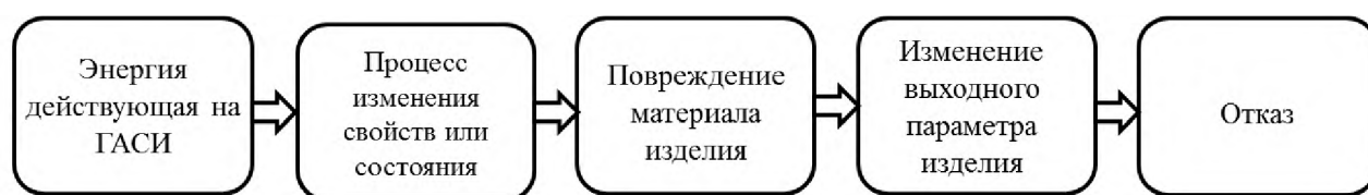
Рис. 2. Процессы, снижающие работоспособность изделия
