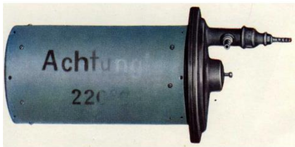
Рис. 2 Использование термохромных красок для индикации сильно нагретой поверхности на технологическом оборудовании
