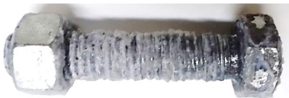
Рис. 1. Болт М12 с гайкой с продуктами коррозии цинка (выдержка 14 суток)
