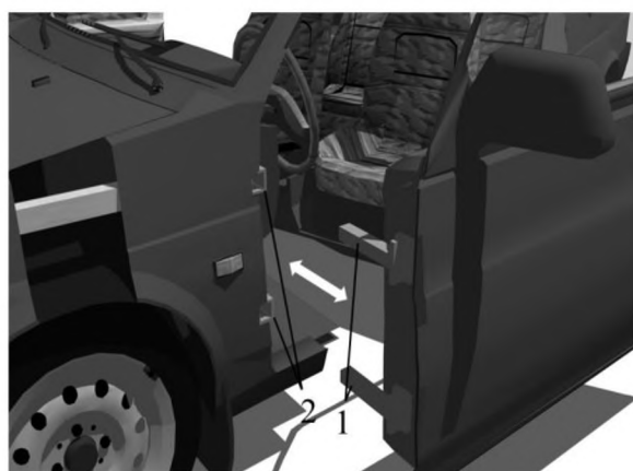
Рис. 5. Общий вид механизма быстросъемного крепления разборных элементов тренажера «Легковой автомобиль при ДТП» 1 – профильная труба сечением 24 мм, 2 – профильная труба сечением 32 мм
