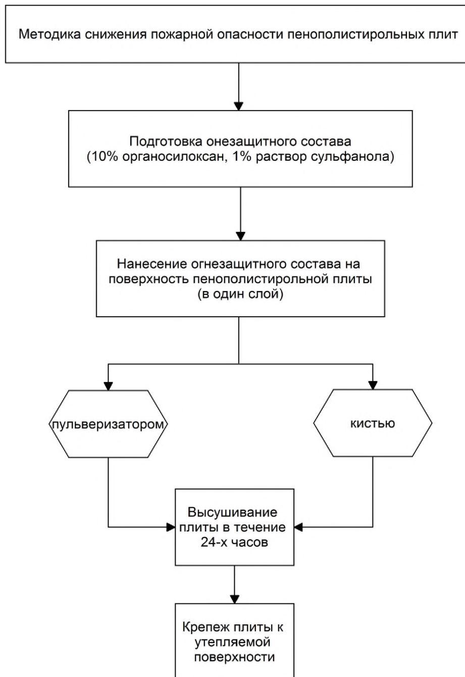
Рис. 2. Методика снижения пожарной опасности пенополистирольных плит
